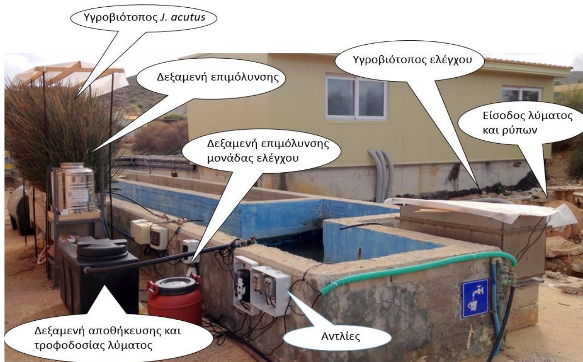
Εικόνα 5: Παρουσίαση του Υγροβιότοπου με τα Juncus acutus και του Υγροβιότοπου Ελέγχου στην εγκατάσταση επεξεργασίας λυμάτων της πόλης των Χανίων.
