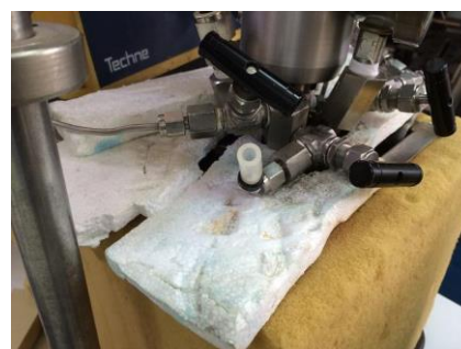
Εικόνα 3.7: Μόνωση ψυκτικού δοχείου.
