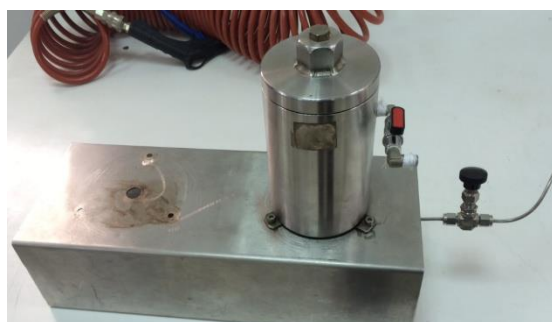
Εικόνα 3.19: Συσκευή τροφοδότησης εμβολοφόρου κελλιού ενός λίτρου.
