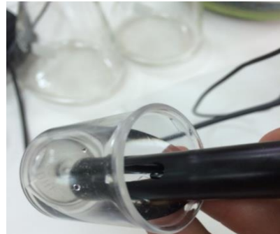
Εικόνα 4.2: Ο ανιχνευτής του ηλεκτρικού αγωγιμόμετρου κατά την καταγραφή.
