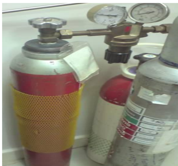
Εικόνα 3.16: Φιάλη φόρτωσης μεθανίου.
