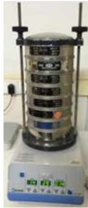
Εικόνα 3.3. Μηχανισμός Ξηρής κοσκίνησης Εργαστηρίου Εμπλουτισμού, Πολυτεχνείου Κρήτης
