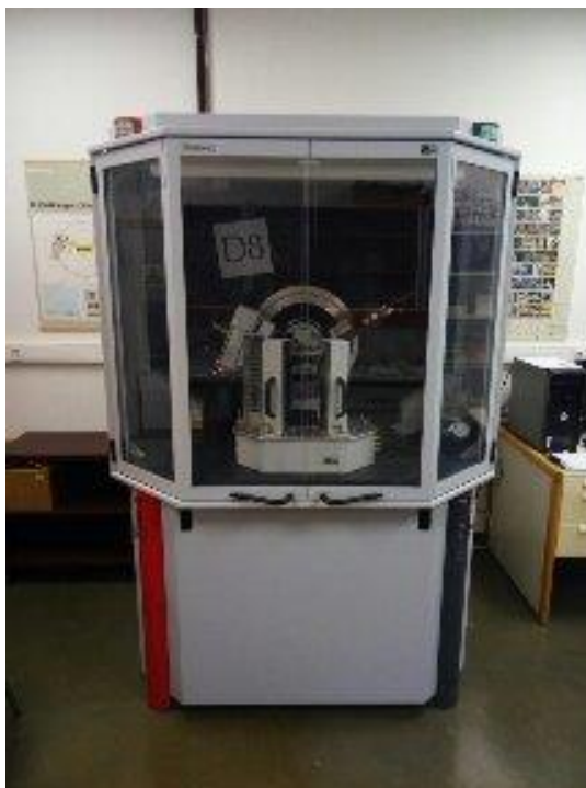
Εικόνα 3.7. Περιθλασίμετρο ακτίνων – X (XRD) του εργαστηρίου Γενικής και Τεχνικής Ορυκτολογίας του Πολυτεχνείου Κρήτης
