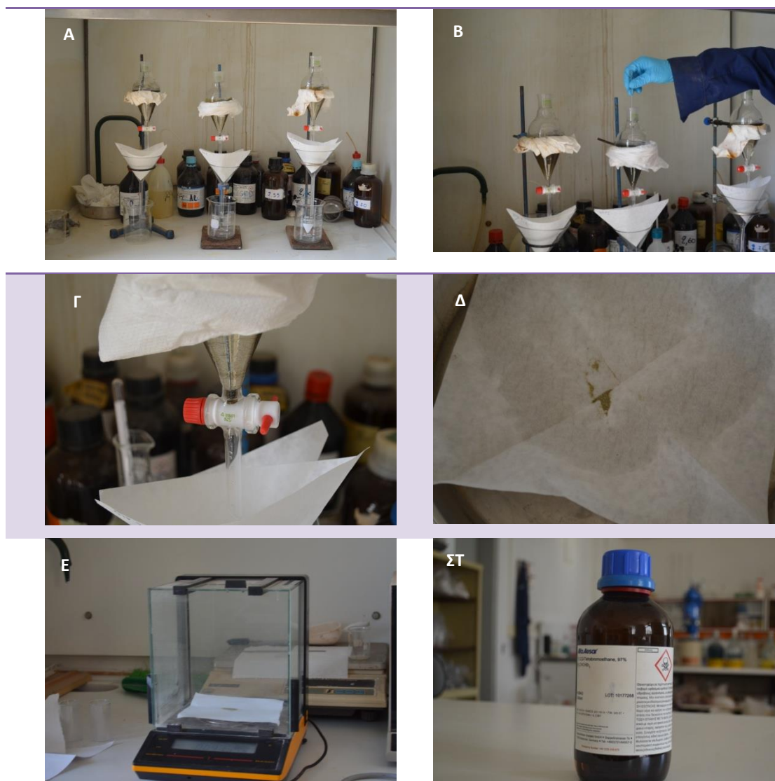
Εικόνα 3.6. Συγκεντρωτικές εικόνες από τη διαδικασία που ακολουθήθηκε: Α) Αριστερα παρουσιάζονται οι χοάνες μέσα στις οποίες τοποθετήθηκε το δείγμα για το διαχωρισμό Β) Διαδικασία της ανάδευσης Γ) Στην τρίτη εικόνα το υλικό που καθιζάνει και πρέπει να συλλεχθεί Δ) Συλλογή υλικού για να ξεπλυθεί με ακετόνη. Ε) Ζύγιση του υλικού πριν αυτό αποθηκευτεί σε αεροστεγές δοχείο ΣΤ) Εικόνα από το δοχείο που περιέχει το βαρύ υγρό
