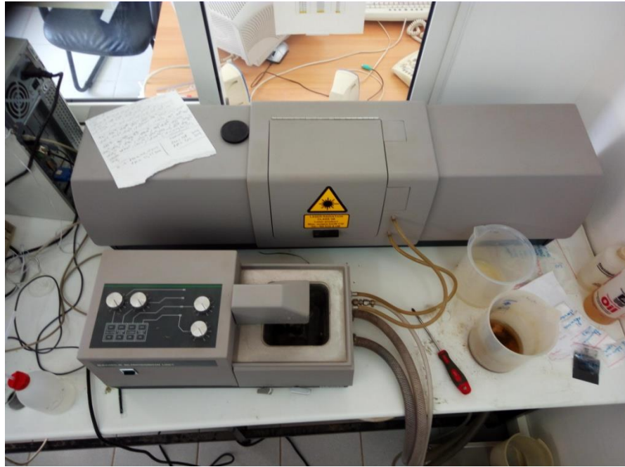
Εικ. 3.5. Κοκκομετρικός αναλυτής ακτίνων laser του Εργαστηρίου Εμπλουτισμού του Πολυτεχνείου Κρήτης
