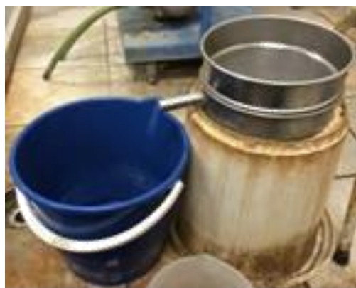
Εικ 3.4. Πραγματοποίηση υγρής κοσκίνησης
