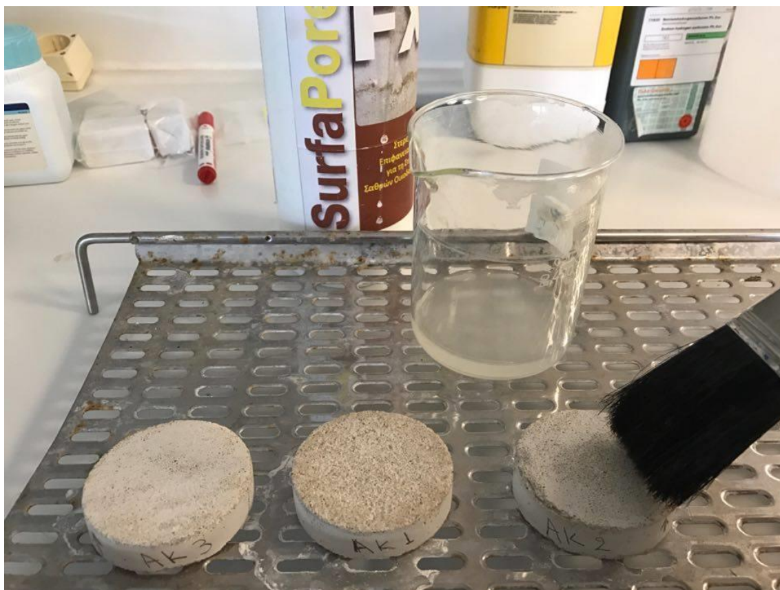
Εικόνα 13: Εφαρμογή Υδατικού SurfaPore Fx σε Ασβεστοκονιάματα
