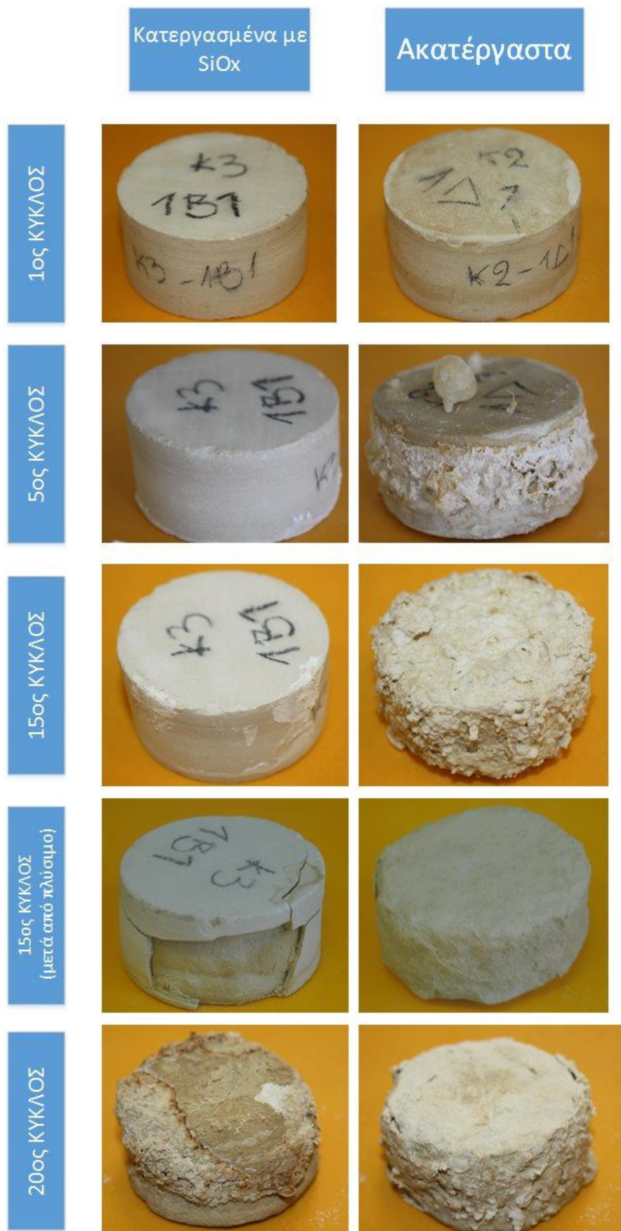
Σχήμα 39: Φωτογραφίες δοκιμίων Αλφά (κετεργασμένων και μη) μέχρι και τον 20 ο κύκλο γήρανσης
