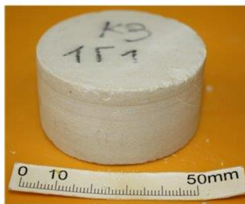
Σχήμα 5: Κατεργασμένα δοκίμια Αλφά με Αλκοολούχο SurfaPore Fx (SiOx)
