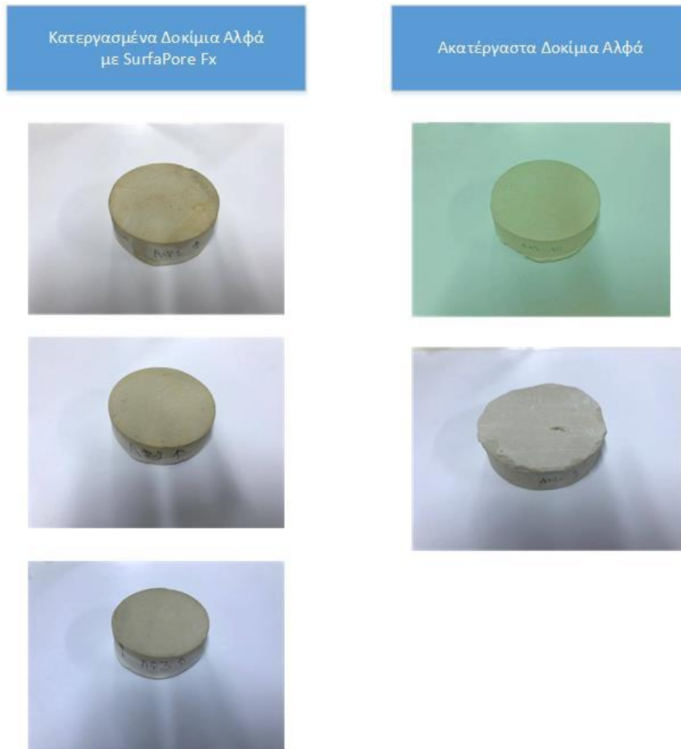
Σχήμα 6: Κατεργασμένα και Ακατέργαστα δοκίμια Αλφά με Υδατικό SurfaPore Fx
