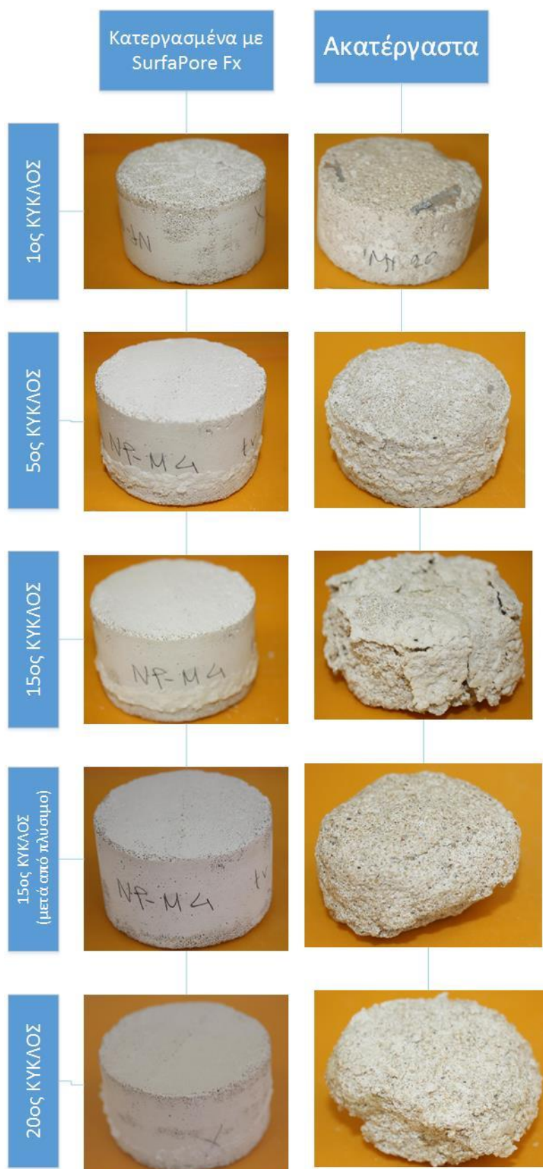
Σχήμα 34: Φωτογραφίες ασβεστοκονιαμάτων (κετεργασμένων και μη) μέχρι και τον 20 ο κύκλο γήρανσης.
