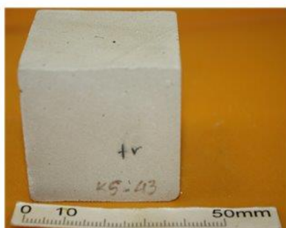
Σχήμα 4: Κατεργασμένα δοκίμια Αλφά/Ασβεστοκονιάματα με Υδατικό SurfaPore Fx
