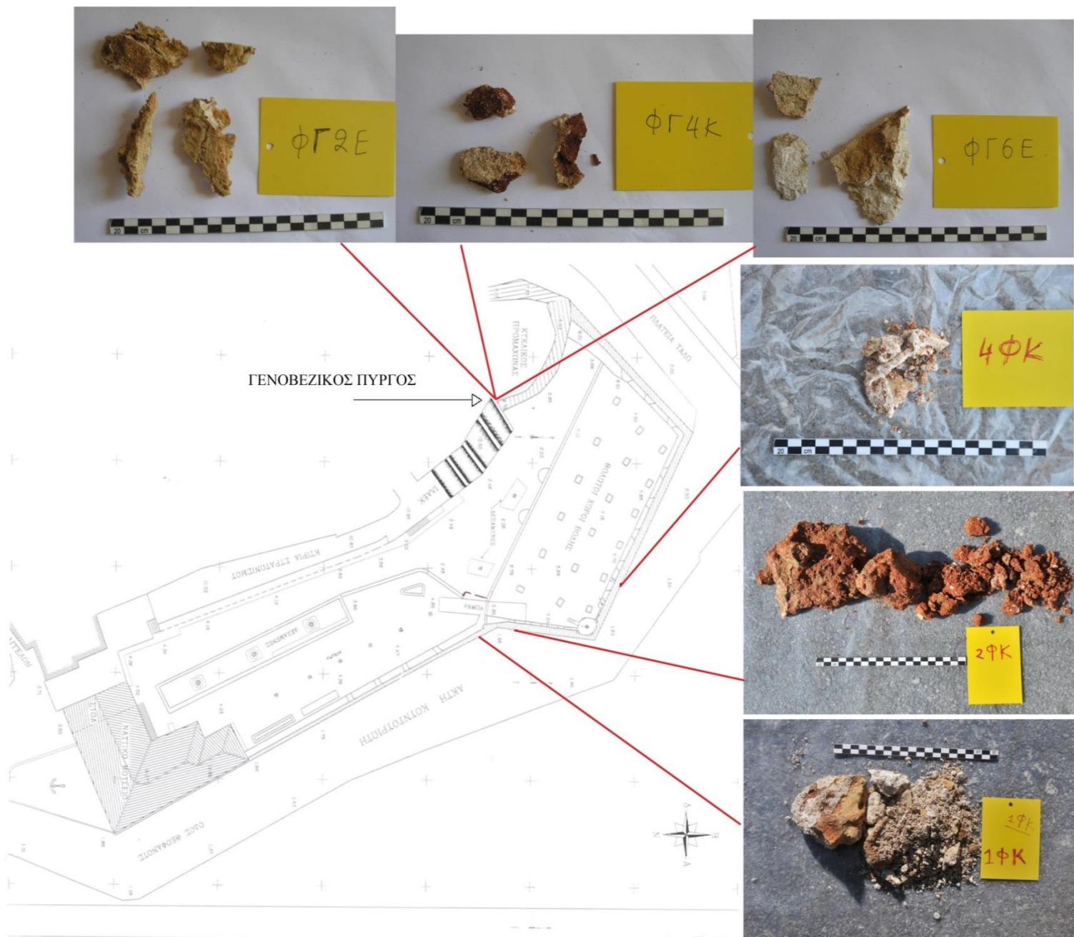
Σχήμα 3: Κάτοψη χώρου – Θέσεις δειγματοληψίας των προς ανάλυση κονιαμάτων/επιχρισμάτων
