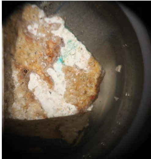
Εικόνα 51: Φωτογραφία στιλπνής τομής επιχρίσματος ΦΓ-6Ε
