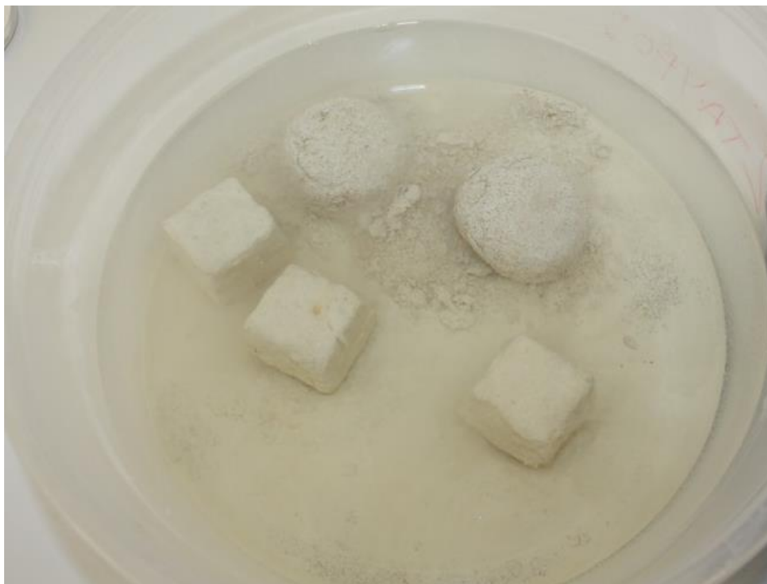
Εικόνα 18: Εμβάπτιση των δειγμάτων σε απιονισμένο νερό πριν από το 15ο κύκλο και μετά από 24 ώρες.
