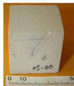
Σχήμα 4: Κατεργασμένα δοκίμια Αλφά/Ασβεστοκονιάματα με Υδατικό SurfaPore Fx
