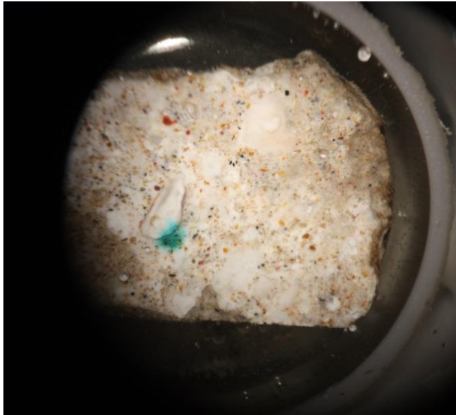
Εικόνα 47: Φωτογραφία στιλπνής τομής επιχρίσματος ΦΓ-2Ε
