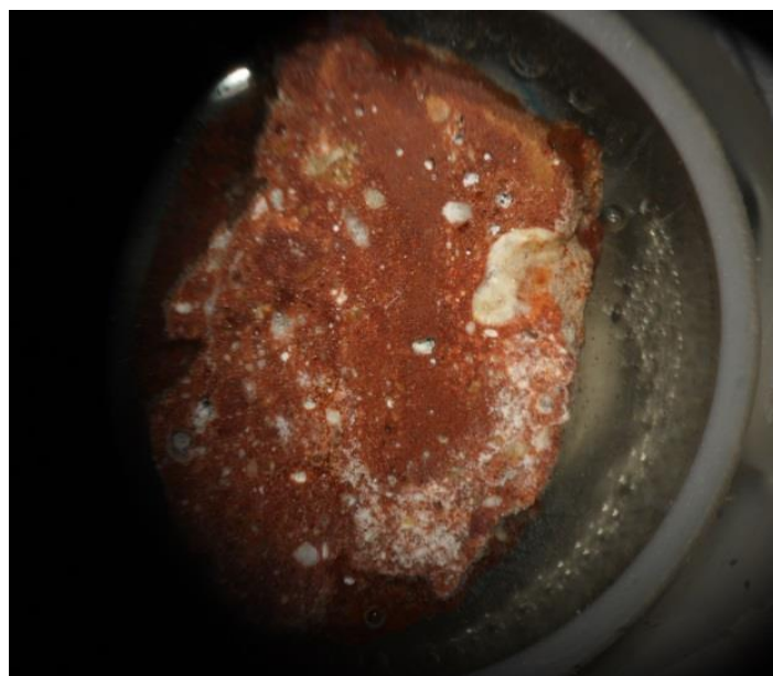
Εικόνα 43: Φωτογραφία στιλπνής τομής κονιάματος ΦΚ-2
