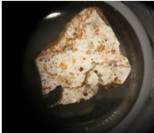
Εικόνα 41: Φωτογραφία στιλπνής τομής κονιάματος ΦΚ-1.
