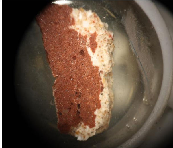
Εικόνα 49: Φωτογραφία στιλπνής τομής κονιάματος ΦΓ-4Κ
