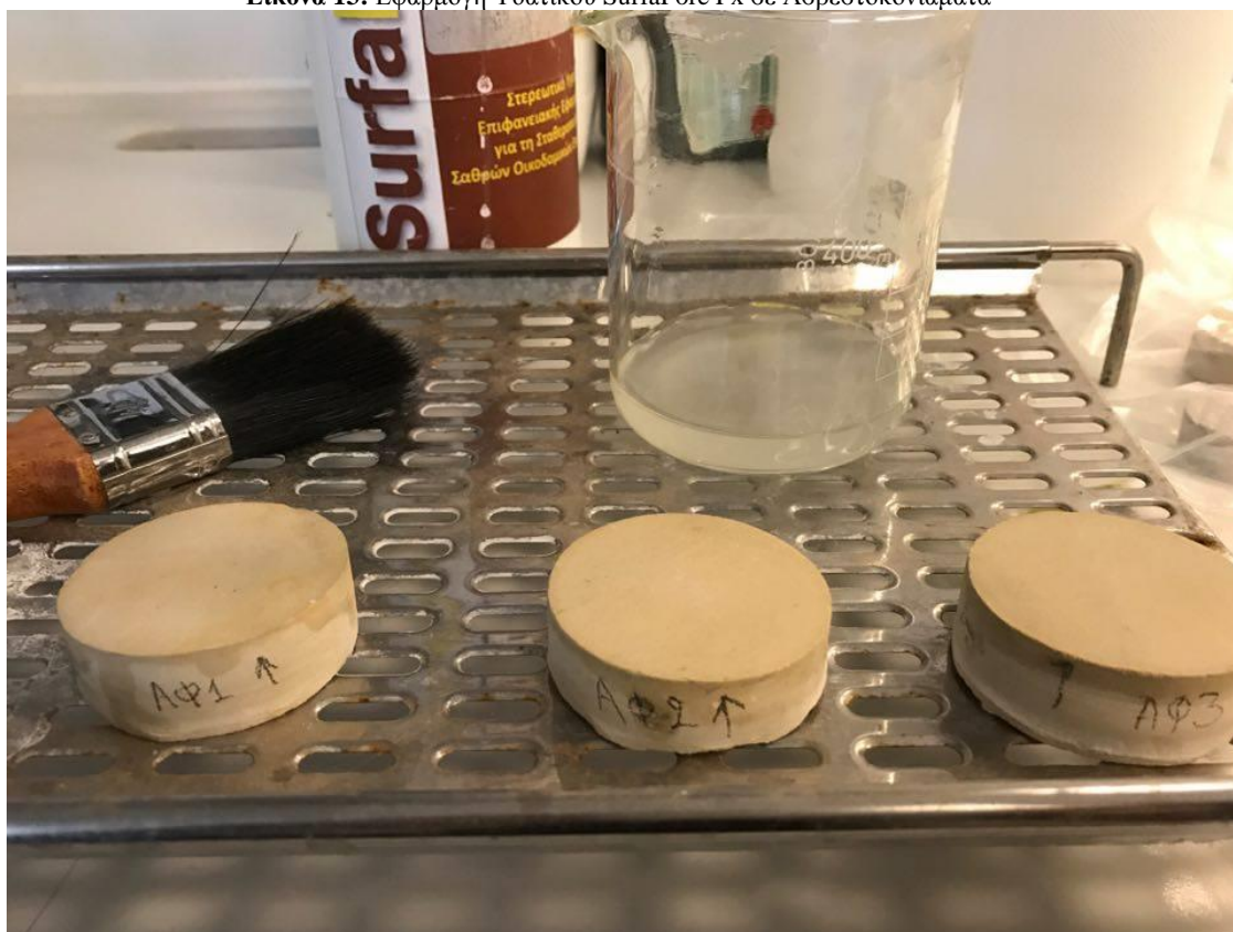
Εικόνα 14: Εφαρμογή Υδατικού SurfaPore Fx σε δοκίμια Αλφά
