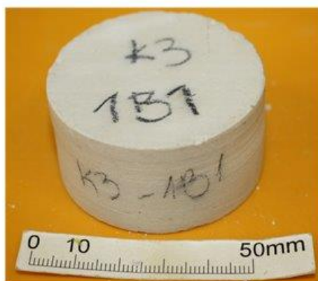
Σχήμα 5: Κατεργασμένα δοκίμια Αλφά με Αλκοολούχο SurfaPore Fx (SiOx)
