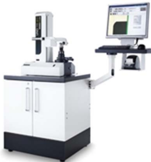
Σχήμα 4.5: Συσκευή προорύθμισης εργαλείων Microset Uno 115eco
