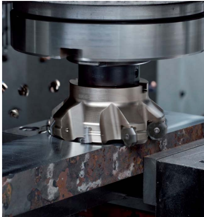
Σχήμα 3.3 : Στιγμιότυπο από κατεργασία φραιζαρίσματος προσώπου
