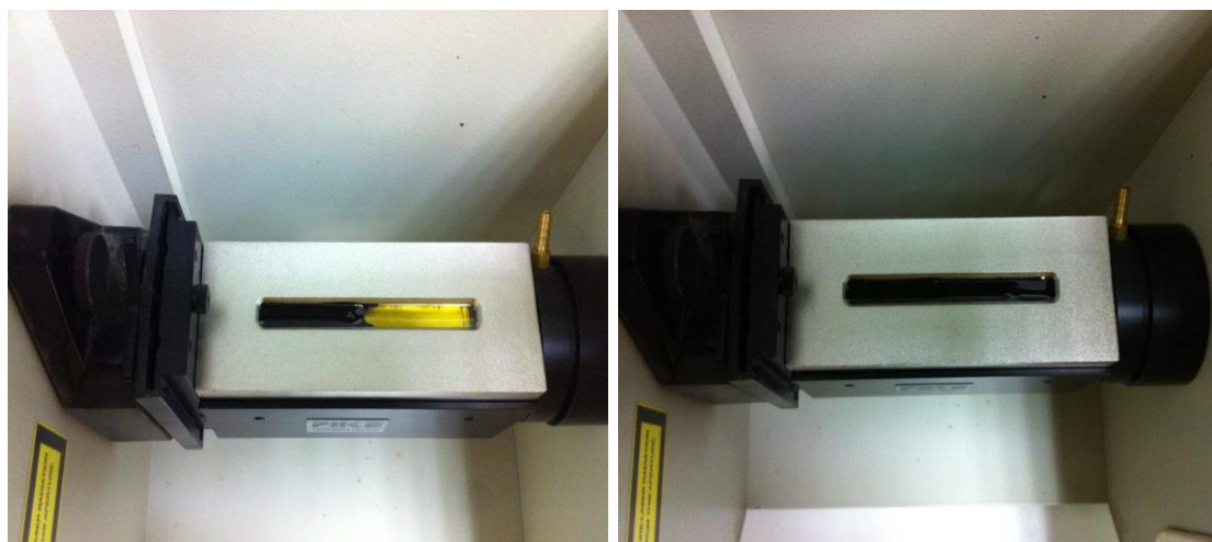
Εικόνα 3.5: Κελί εισαγωγής δείγματος
