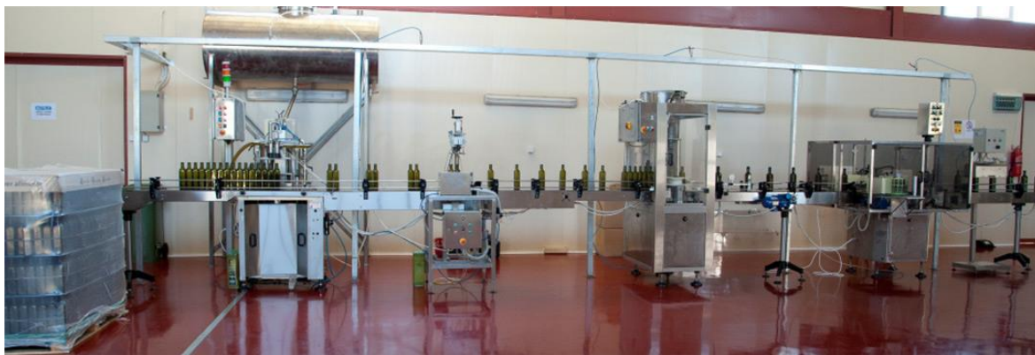
Εικόνα 2: Γραμμή τυποποίησης ελαιολάδου, http://www.eleones-orino.gr/
