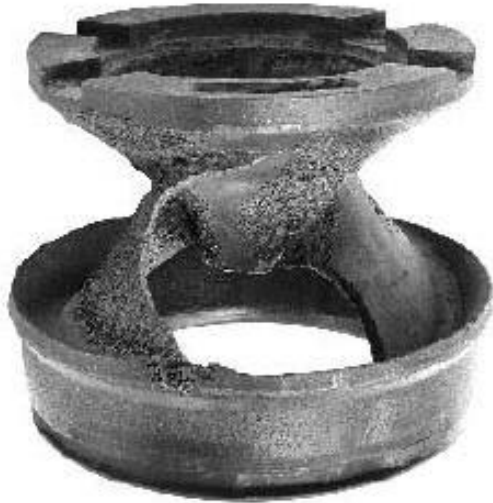
Εικόνα 9: Μορφή σπηλαιώσης στην πτερωτή αντλίας.
