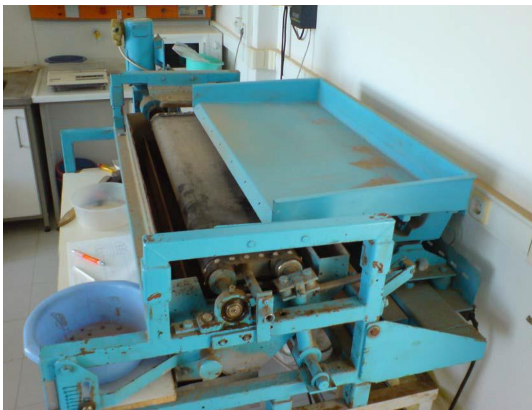
Σχήμα 2.4: Ταινιοφόρος μαγνητικός διαχωριστής του εργαστηρίου Εμπλουτισμού Μεταλλευμάτων.
