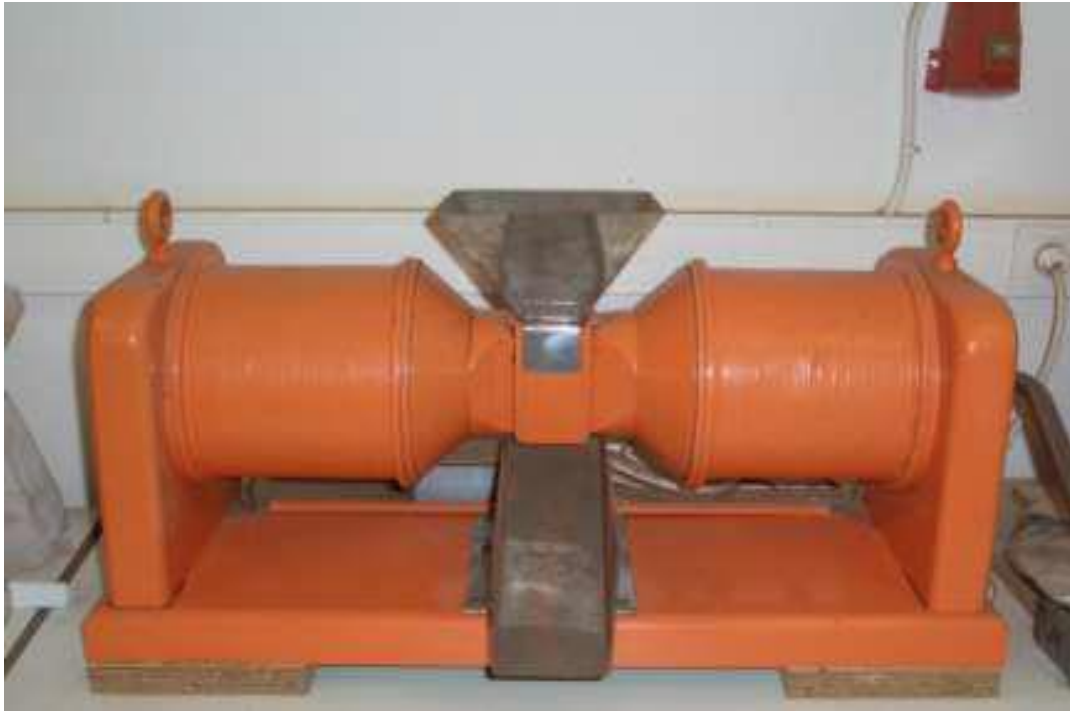
Σχήμα 2.7: Υγρός μαγνητικός διαχωριστής υψηλού πεδίου κλίσης του εργαστήριου Εμπλουτισμού Μεταλλευμάτων.
