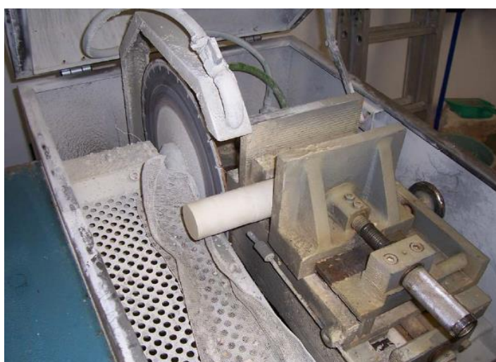
Εικόνα 4. 3. Εργαστηριακό δισκοπρίονο (από Κουβάλας 2006)
