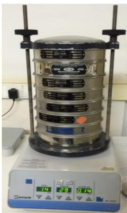
Εικόνα4.10. Εργαστηριακή διαδικασία ξηρής κοσκίνησης με μηχανή κοσκίνησης
