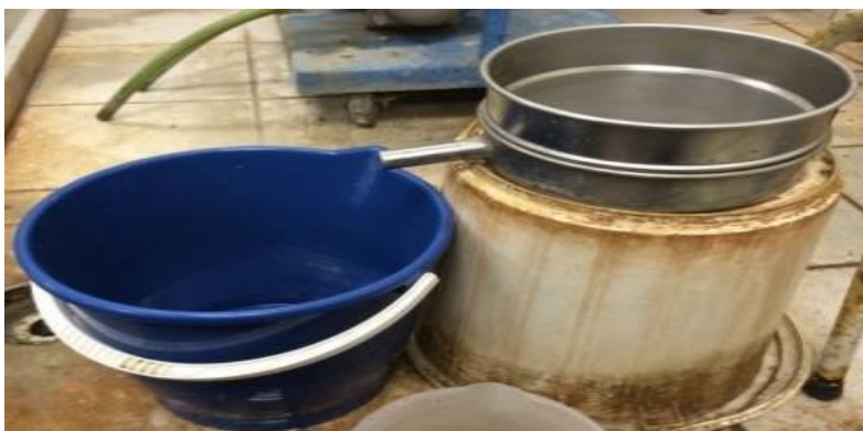
Εικόνα4.9. Εργαστηριακή διαδικασία υγρής κοσκίνησης
