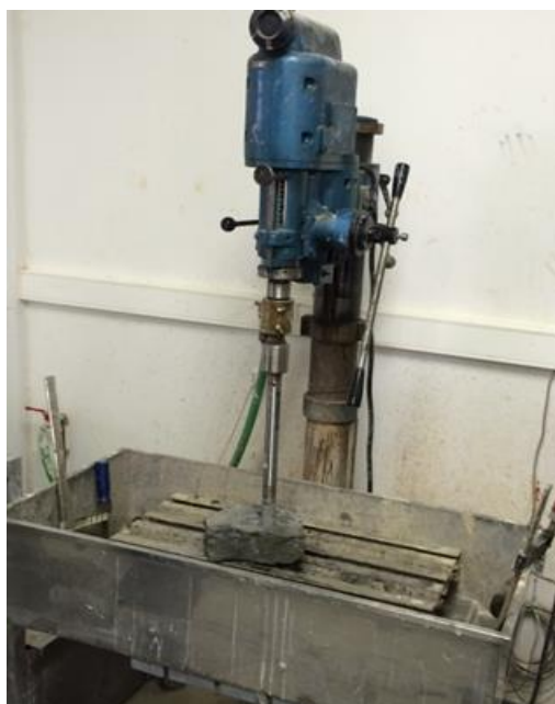
Εικόνα 4. 2. Εργαστηριακός πυρηνολήπτης(καροταρία)
