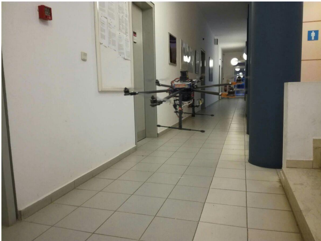
Εικόνα 5.25: Χρήση συσκευής LiDAR ενσωματωμένη σε UAV για την αποτύπωση εσωτερικού χώρου.
