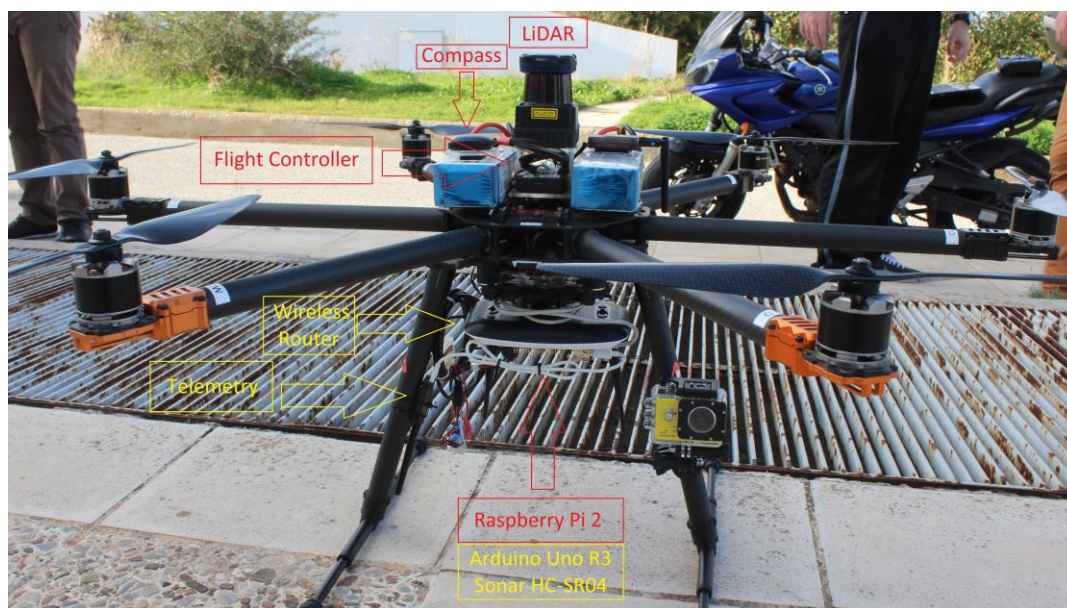
Εικόνα 5.24: Το σύστημα μέτρησης ενσωματωμένο στην εναέρια πλατφόρμα.
