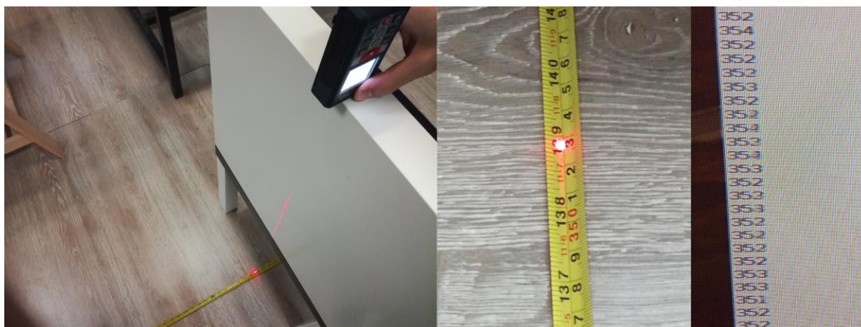
Εικόνα 5.20: Σύγκριση αποτελεσμάτων Sonar – μετροταινίας.
