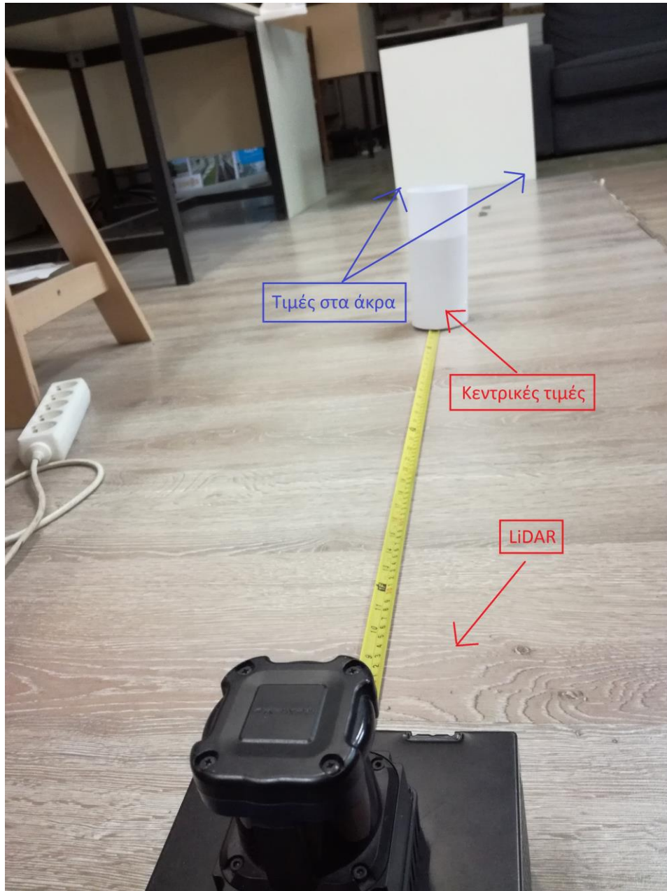
Εικόνα 5.8: Η διάταξη μετρήσεων με το LiDAR με την παρεμβολή εμποδίου.
