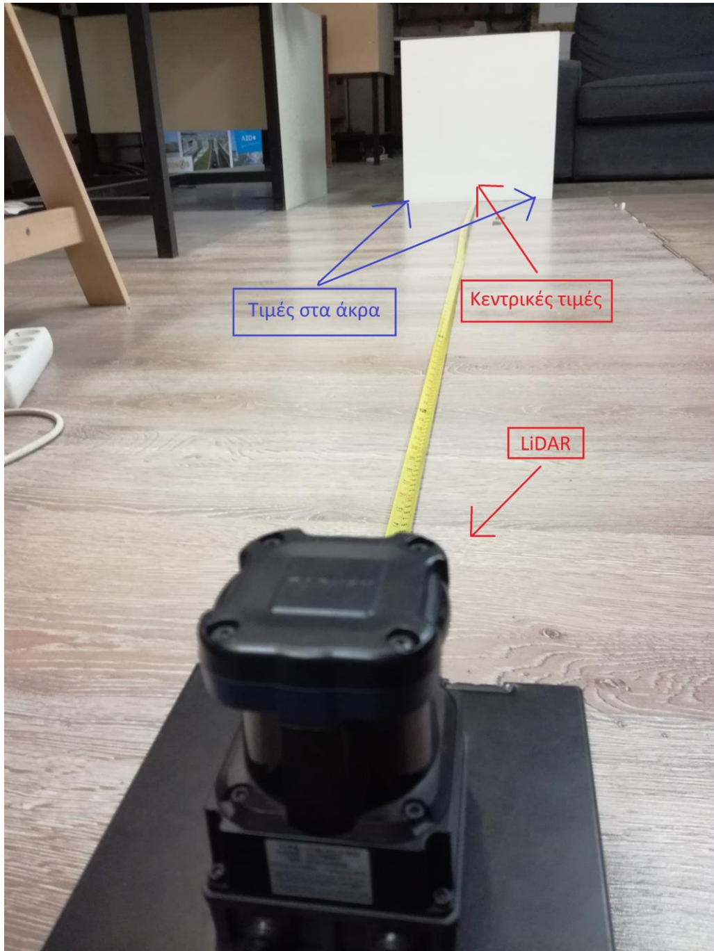
Εικόνα 5.1 Η διάταξη μετρήσεων με το LiDAR.
