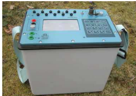
Εικόνες 3.2: (α) Πολυκάναλα καλώδια, (β) SYSCAL Pro Switch™ (Κεσόγλου, 2011)
