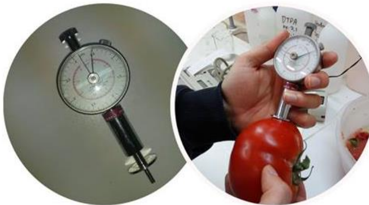
Εικόνα 2.6: Το GY-2 Penetrometer (αριστερά) και ο τρόπος χρήσης του (δεξιά).
