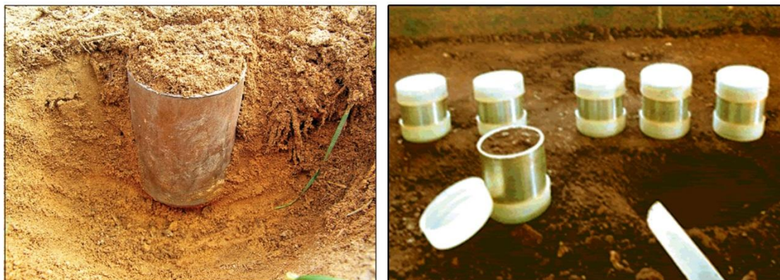
Εικόνα 2.1: Δειγματοληψία χώματος για τον προσδιορισμό της φαινομενικής πυκνότητας του εδάφους.
