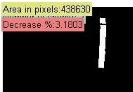
Φωτογραφία 3.1.6: Τρίτο δείγμα από αριστερά μετά την τοποθέτηση τους στη μηχανή θρυμματισμού για 4 ώρες
