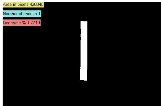
Φωτογραφία 3.3.4: Πρώτο δείγμα από αριστερά μετά την τοποθέτηση τους στη μηχανή θρυμματισμού για 12 ώρες
