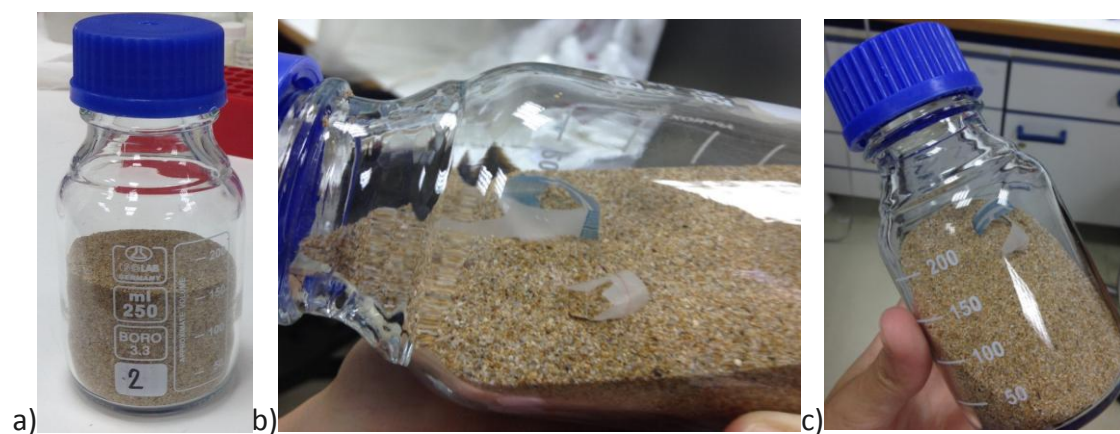
Φωτογραφία 2.9: α) Το δοχείο γεμάτο με άμμο μέχρι τα 150 ml, χωρίς το δείγμα. b,c) το δοχείο με το δείγμα
