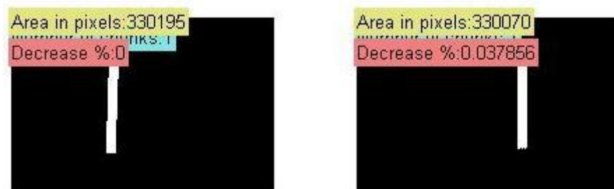
Φωτογραφία 3.10: Δείγματα control πριν και μετά την τοποθέτησή τους στη μηχανή θρυμματισμού για 8 ώρες
