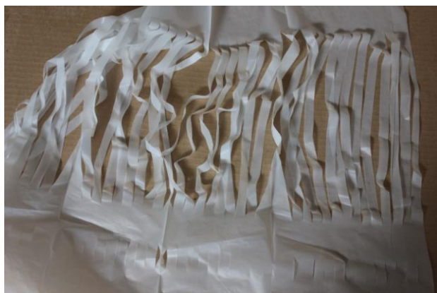
Φωτογραφία 2.1: πλαστική σακούλα HDPE κομμένη με λωρίδες
