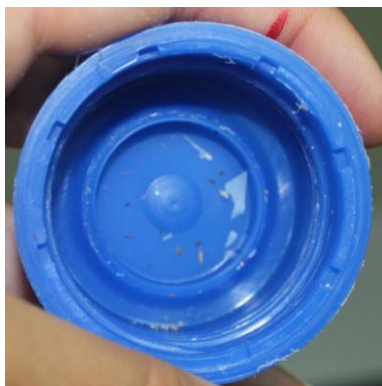
Φωτογραφία 2.12: Προσκολλημένα θρύμματα από τα πλαστικά δείγματα πάνω στο καπάκι του δοχείου μετά από τη συσκευή θρυμματισμού.
