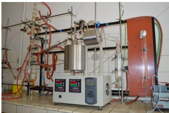
Φωτογραφία 1.8 : μηχανή δημιουργίας συνθηκών για τη διαδικασία της θερμικής αποδόμησης(πηγή:stuba.sk)
