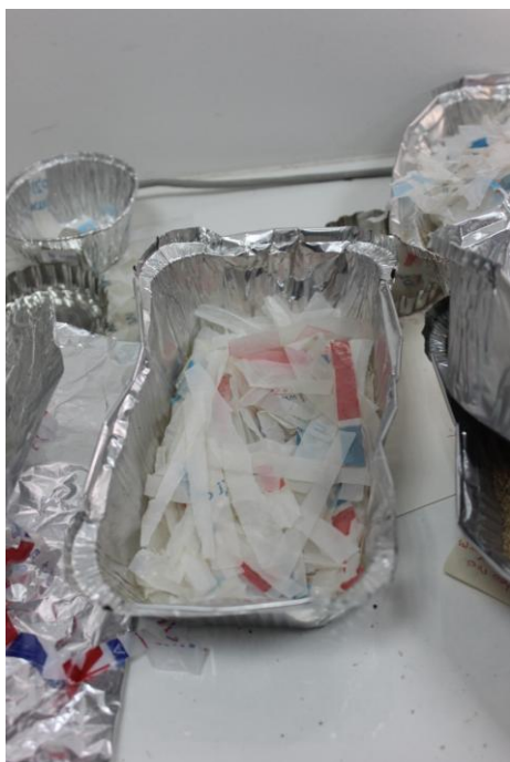
Φωτογραφία 2.2: πλαστική σακούλα ΥΝΚΑ κομμένη σε λωρίδες
