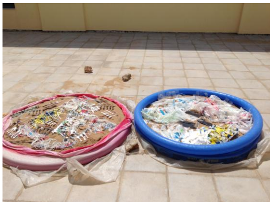
Φωτογραφία 2.4: Πισίνες με άμμο σε εξωτερικό χώρο με δείγματα από σακούλες ΥΝΚΑ
