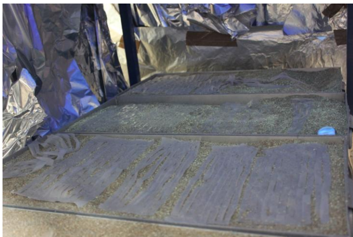
Φωτογραφία 2.3: Σιδερένια δοχεία με άμμο και HDPE δείγματα
