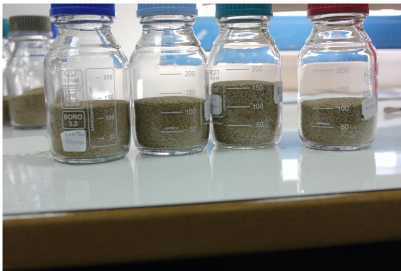
Φωτογραφία 2.6: δοχεία που χρησιμοποιήθηκαν για την τοποθέτηση των δειγμάτων μέσα στη μηχανή θρυμματισμού
