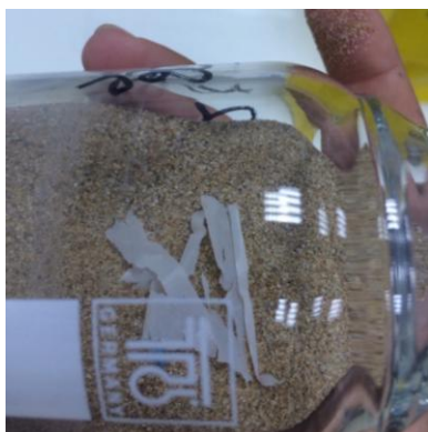
Φωτογραφία 2.10: Πολυκαιρισμένο δείγμα, ύστερα από λίγες ώρες στο GFL, παρατηρήθηκε κάποιος μικρός θρυμματισμός.
