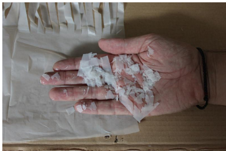
Φωτογραφία 3.14: Δείγμα HDPE μετά από έκθεση σε UV-A ακτινοβολία για διάστημα 6 μηνών
