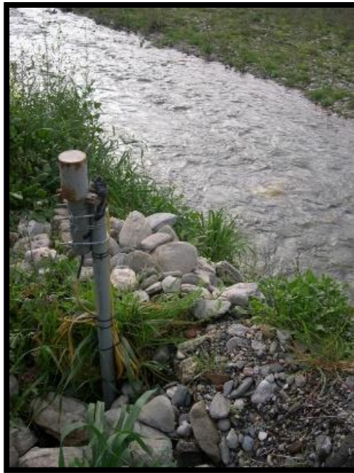
Εικόνα 3.12. Θέση Κελεφίνα Κλαδάς. Καταγραφής στάθμης ποταμού με αυτόματο καταγραφέα (levellogger)
