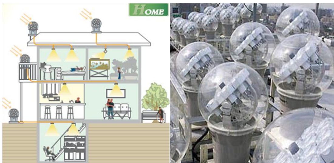
Εικόνες 3.8, 3.9: Χρήση του συστήματος Hamawari σε οικιακό περιβάλλον και πολλαπλοί συλλέκτες Hamawari στην οροφή κτηρίου.
