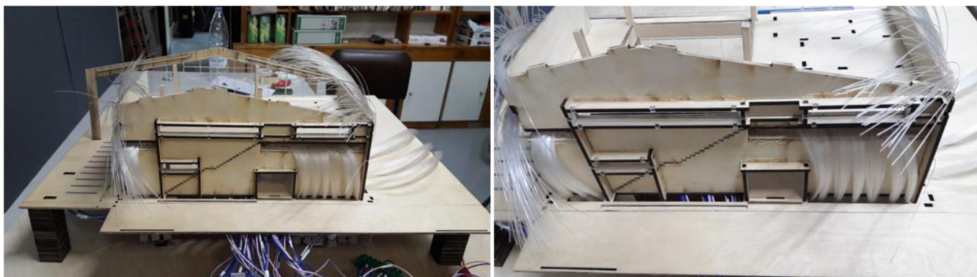
Εικόνα 6.36-6.37: Κατακόρυφη τοποθέτηση πηγών φωτισμού LED στο κάτω μέρος της μακέτας
