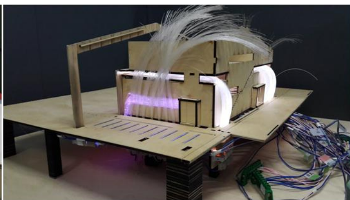
Εικόνα 6.43-6.46: Τοποθέτηση οπτικών ινών ισογείου
