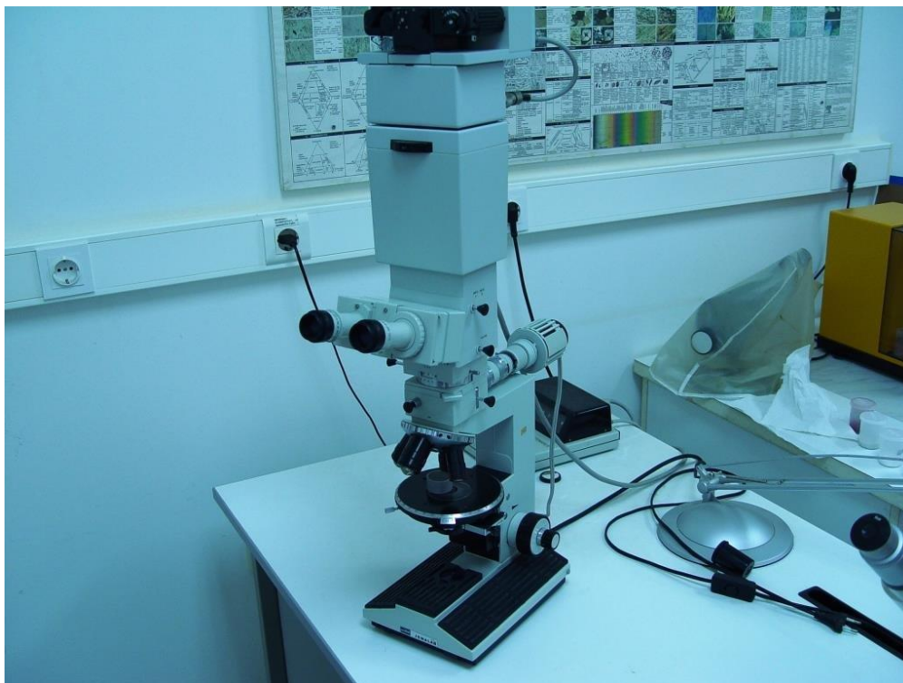
Εικόνα 4.1: Μικροσκόπιο διερχόμενου και ανακλώμενου φωτός του Εργαστηρίου Γενικής και Τεχνικής Ορυκτολογίας του Πολυτεχνείου Κρήτης.
