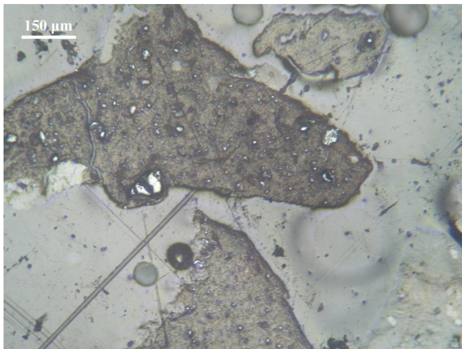
Εικόνα 7.2: Συνδετικό υλικό με μη αποδεσμευμένους κόκκους αιματίτη. Δείγμα PK3E, ελαφρύ (-1+0,250 mm). Ανακλώμενο φως, //Nicols.
