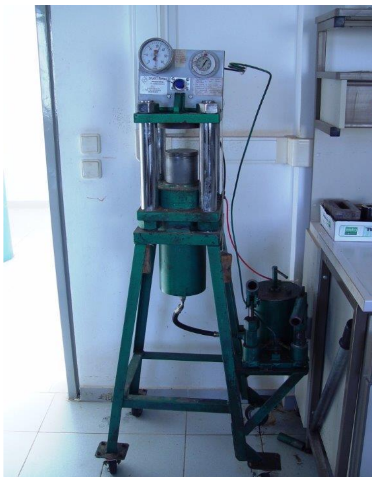
Εικόνα 4.7: Υδραυλική πρέσα για κατασκευή ταμπλέτας για XRF
