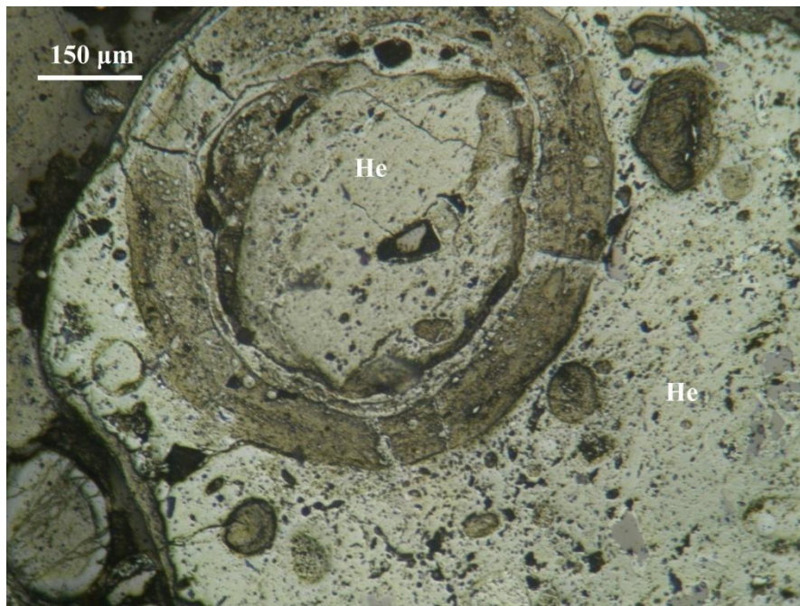
Εικόνα 5.5: Ωοειδές από αιματίτη (He) ενσωματωμένο σε ένα σύνθετο σφαιροειδές αιματιτικής σύστασης.
