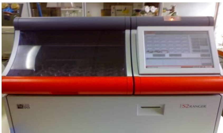
Εικόνα 4.5: Φασματοσκόπιο ακτίνων-X φθορισμού του Εργαστηρίου Ανόργανης Γεωχημείας, Οργανικής Γεωχημείας και Οργανικής Πετρογραφίας του Πολυτεχνείου Κρήτης.
