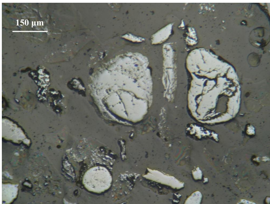
Εικόνα 7.9: Πλήρως αποδεσμευμένοι κόκκοι αιματίτη. Δείγμα PK4M, μαγνητικό ( -0,250+0,063 mm), Ανακλώμενο φως, // Nicols
