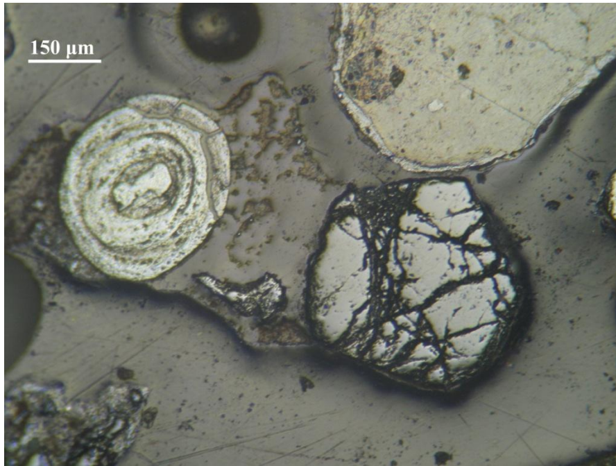
Εικόνα 7.1: Μη αποδεσμευμένοι κόκκοι αιματίτη (ωοειδές) και χρωμίτη. Δείγμα PK3B, βαρύ (-1+0,250 mm). Ανακλώμενο φως, //Nicols.
