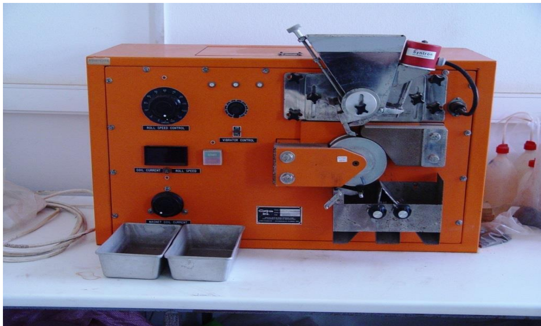
Εικόνα 7.5: Ο ξηρός μαγνητικός διαχωριστής της Carpco (High Intensity Induced Magnetic Separator Carpco MIH 111-5).
