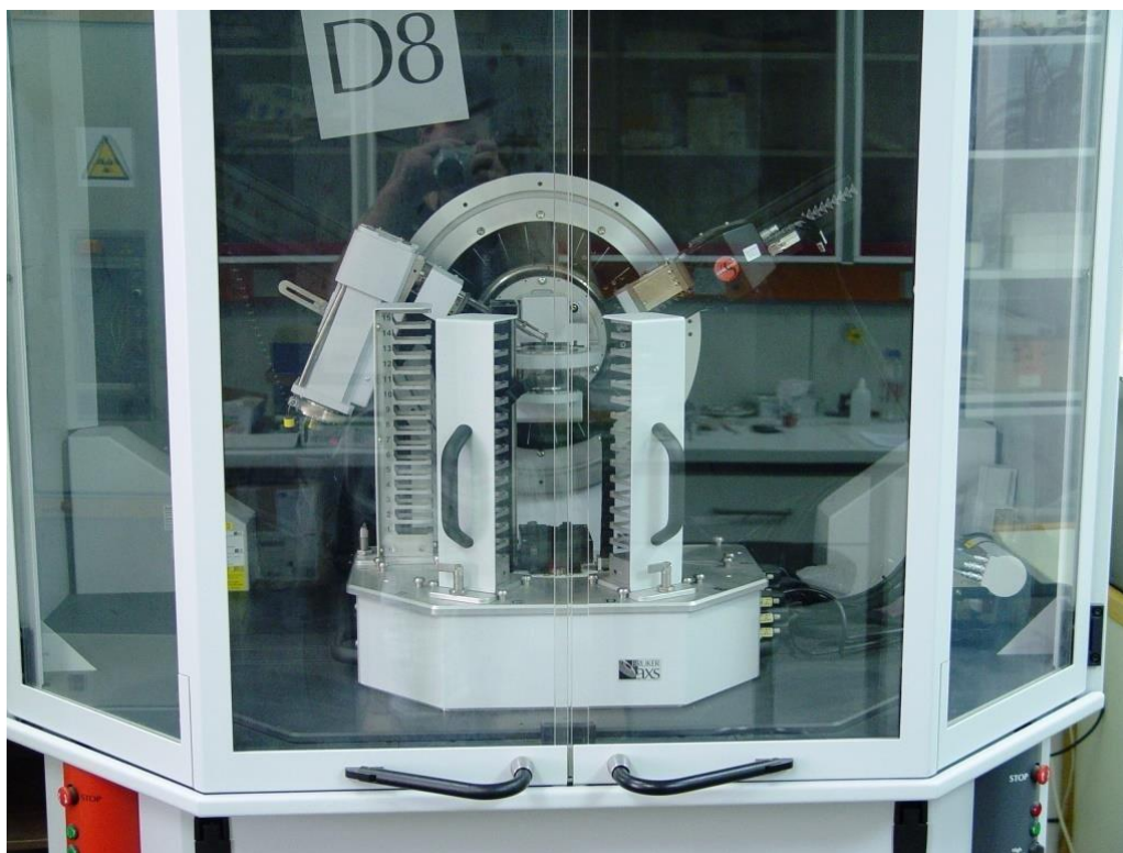
Εικόνα 4.2: Περιθλασίμετρο ακτίνων-X (XRD) του Εργαστηρίου Γενικής και Τεχνικής Ορυκτολογίας του Πολυτεχνείου Κρήτης.
