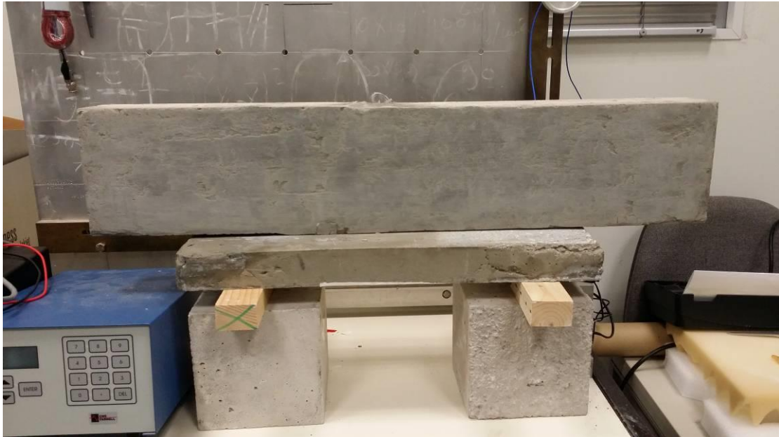
Σχήμα 30: Το δοκίμιο 4 μετά την τοποθέτηση υλικού πλήρωσης/επικάλυψης
