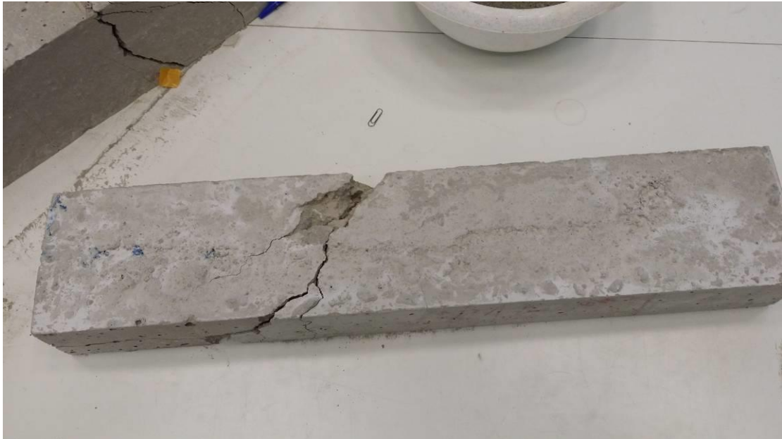
Σχήμα 28: Το δοκίμιο 4 πριν την επικάλυψη με το υλικό πλήρωσης/επικάλυψης
