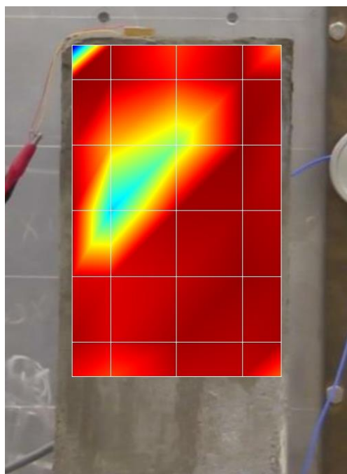
Σχήμα 27: Χρωματικός χάρτης μέσης τιμής ταχυτήτων επιφάνειας για συχνότητα διέγερσης 500Hz
