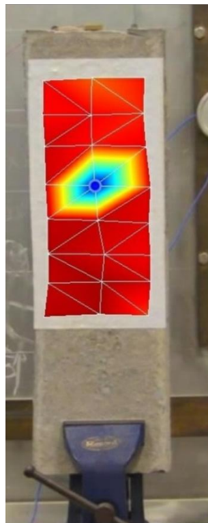
Σχήμα 17: Χρωματικός χάρτης συχνотικού φαινομένου πειράματος 2 σε συχνότητα διέγερσης 500Hz
