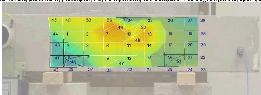
Σχήμα 47: Στιγμιότυπα της απόκρισης της επιφάνειας για το δοκίμιο 4 σε συχνότητα διέγερσης 250Hz
