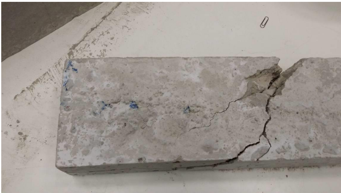
Σχήμα 29: Εστίαση στην περιοχή αστοχίας του δοκιμίου 4 πριν την τοποθέτηση υλικού πλήρωσης/επικάλυψης
