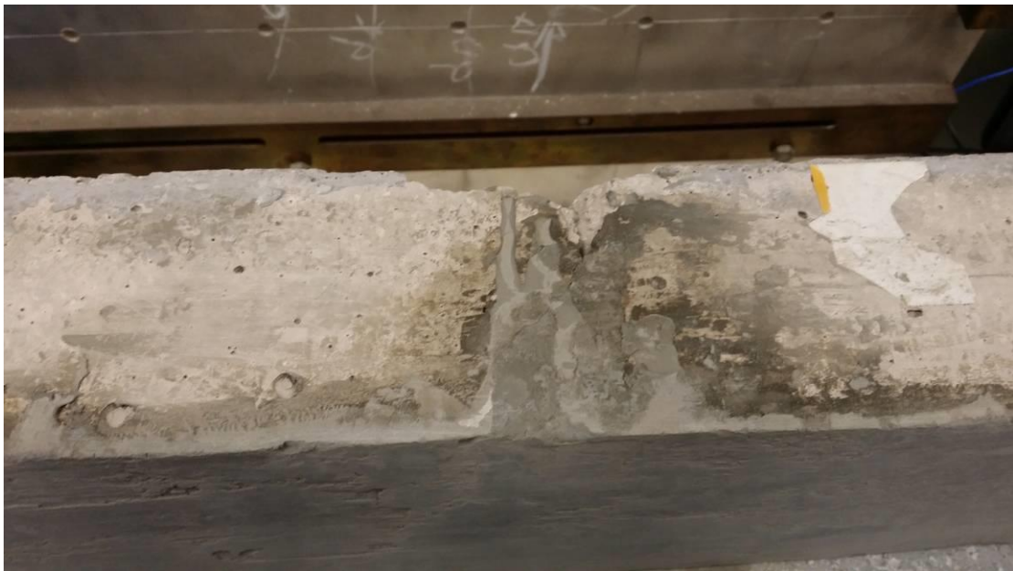
Σχήμα 31: Εστιασμένη εικόνα στο πάνω μέρος του δοκιμίου 4 με εμφανή διαφορά στην περιοχή πλήρωσης και του πάχους της επίστρωσης
