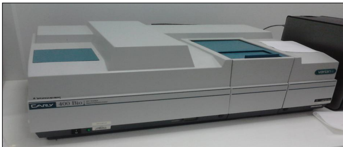
Εικόνα 3.6. Φασματοφωτόμετρο διπλής δέσμης του οίκου Varian (Cary 400 UV/Vis Spectrophotometer).
