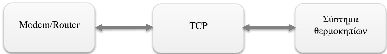
Σχήμα 4-6 Επικοινωνία του συστήματος των θερμοκηπίων με το modem/router χρησιμοποιώντας διεπαφή TCP
