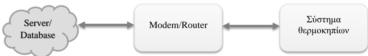
Σχήμα 4-5 Επικοινωνία Server με το σύστημα των θερμοκηπίων μέσω modem/router
