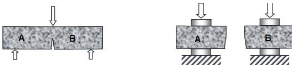
Εικόνα 2: Διάταξη κάμψης (αριστερά) και θλίψης (δεξιά)
