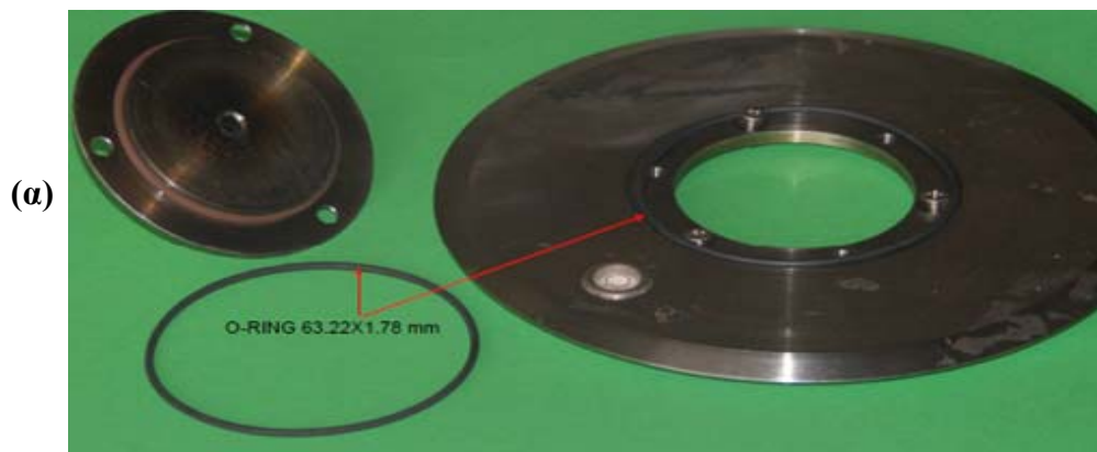
Εικόνα 3.17. Στεγανοποίηση κάτω μέρους του θερμοζυγού
