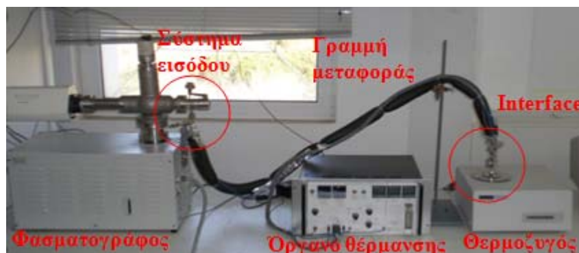
Εικόνα 3.16. Η κατασκευασθείσα διάταξη TG/MS
