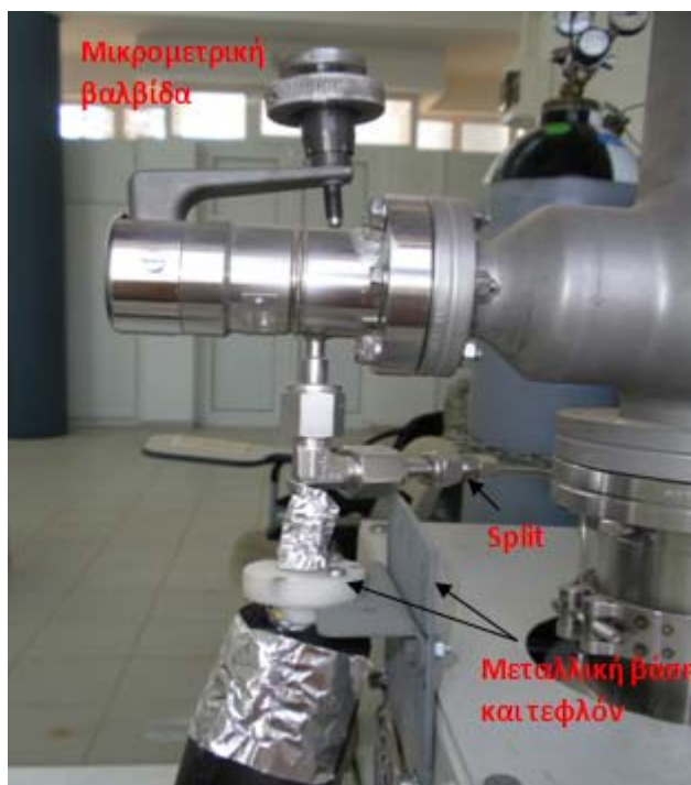
Εικόνα 3.21. Σύστημα εισόδου φασματογράφου μάζας
