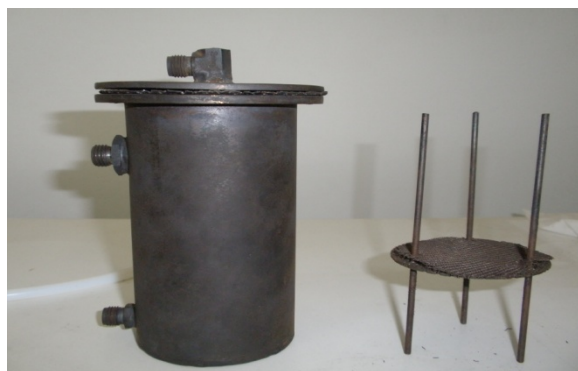
Εικόνα 3.12. Πυρολυτής σταθερής κλίνης
