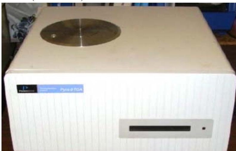
Εικόνα 3.14. Ο θερμοζυγός TGA6 της Perkin Elmer στο Εργαστήριο Εξευγενισμού και Τεχνολογίας Στερεών καυσίμων
