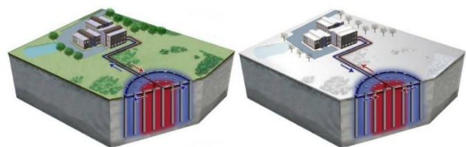
Εικ. 123: Διαγραμματική απεικόνιση συστήματος θερμικών γεωτρήσεων/πασσάλων (energy piles). Κατάλληλο για μεσαίες και μεγάλες εφαρμογές (με ανάγκες πάνω από 700GJ/χρόνο). Εύρος θερμοκρασίας 0-25°C. Απαιτείται χαμηλή ροή υδροφόρου ορίζοντα.
