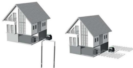
Εικ. 122, πάνω: Συστήματα γεωθερμίας μικρής κλίμακας σε επιφανειακή και εις βάθους στρώση εδάφους.
