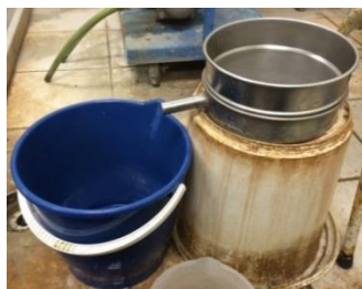
Εικόνα 29: Πραγματοποίηση της υγρής κοσκίνισης
