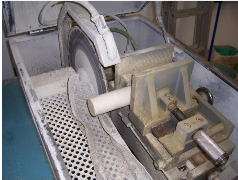
Εικόνα 26: Εργαστηριακό δισκοπρίονο κοπής δοκιμίων πετρωμάτων (από Φέγγος, Κουβελάς 2006)
