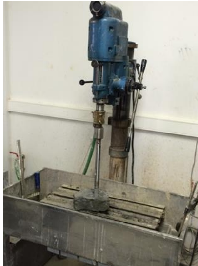
Εικόνα 25: Εργαστηριακός πυρηνολήπτης δοκιμίων
