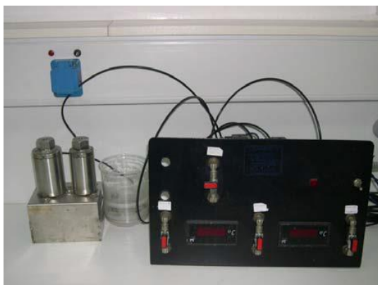
Εικόνα 24: Ποροσίμετρο και πειραματική διάταξη τύπου Boyle (από Γαμβρούδης, 2010 και Βαρότσης, 2014)
