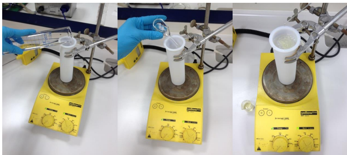
Εικόνα 12. Μίγμα αιθανόλης – υπερκάρθου στο Teflon (αριστερά), προσθήκη H_3BO_3 (μέση), προσθήκη TIP σταγόνα – σταγόνα στο μίγμα (δεξιά)
