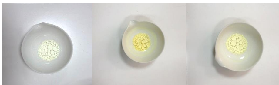
Εικόνα 24. Παρασκευασμένοι φωτοκαταλύτες πριν και μετά τον κλίβανο, \text{TiO}_2 -10-0 (αριστερά), \text{TiO}_2 -0-5 (μέση) και \text{TiO}_2 -10-0,5 (δεξιά)
