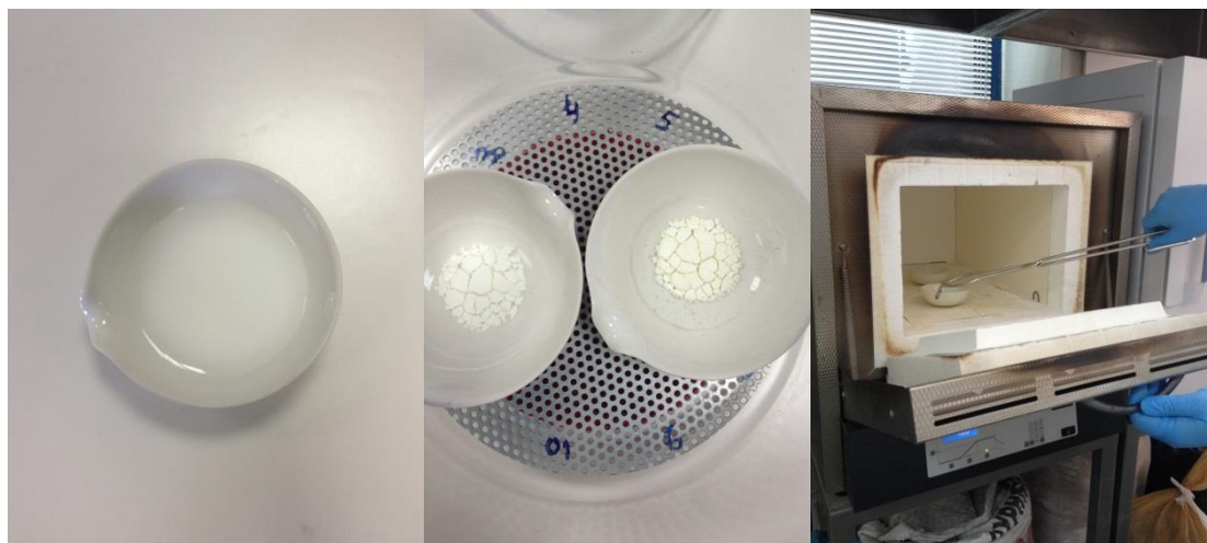
Εικόνα 15. Ξημα μετά τις πλύσεις (αριστερά), ξήρανση ιζημάτων (μέση), χρήση κλιβάνου (δεξιά)
