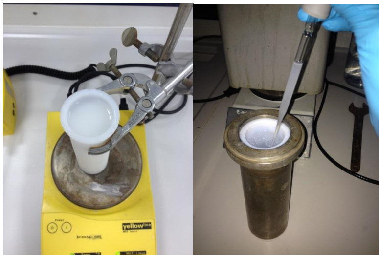
Εικόνα 13. Μίγμα ύστερα από ανάδευση 24 ωρών (αριστερά), μίγμα μετά τον ισοθερμικό αντιδραστήρα (δεξιά)
