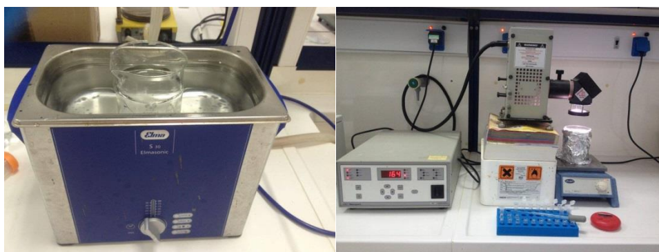
Εικόνα 21. Εφαρμογή υπερήχων για τη διασπορά των φωτοκαταλυτών. Πειράματα φωτοκατάλυσης σε προσομοιωτή ηλιακής ακτινοβολίας
