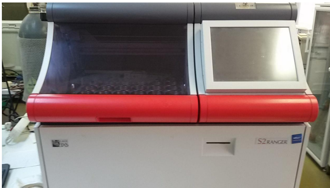
Εικόνα 2.4 Φασματοσκόπιο ακτίνων-X φθορισμού τύπου S2 Ranger του Εργαστηρίου Ανόργανης Γεωχημείας, Οργανικής Γεωχημείας και Οργανικής Πετρογραφίας.
