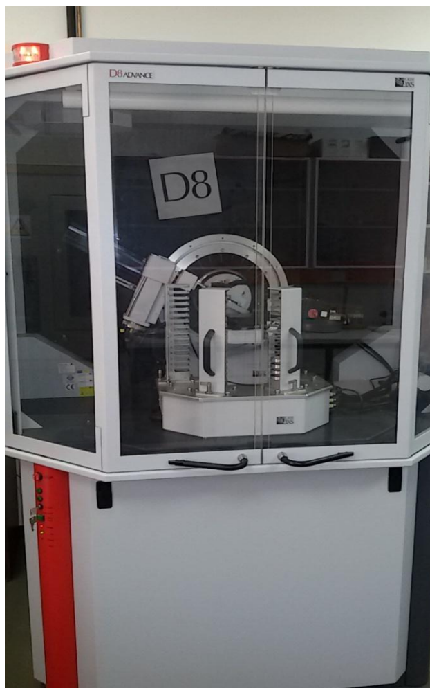
Εικόνα 2.1 Περιθλασίμετρο ακτίνων-X τύπου D8 Advance του Εργαστηρίου Γενικής και Τεχνικής Ορυκτολογίας
