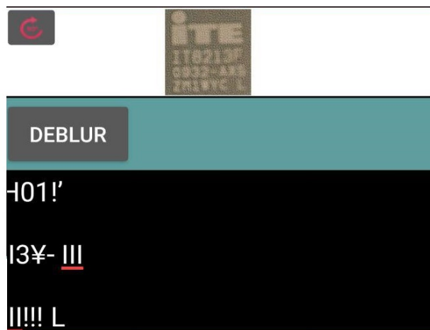
Εικόνα 42: Chip 2x1.5 εκατοστών παράδειγμα δοκιμαστικής εικόνας. Το αποτέλεσμα της αναγνώρισης χωρίς αποκατάσταση της εικόνας εμφανίζεται στο αριστερό μέρος ενώ στο δεξί μέρος παρουσιάζεται το αποτέλεσμα της αναγνώρισης μετά την αποκατάσταση της εικόνας.
