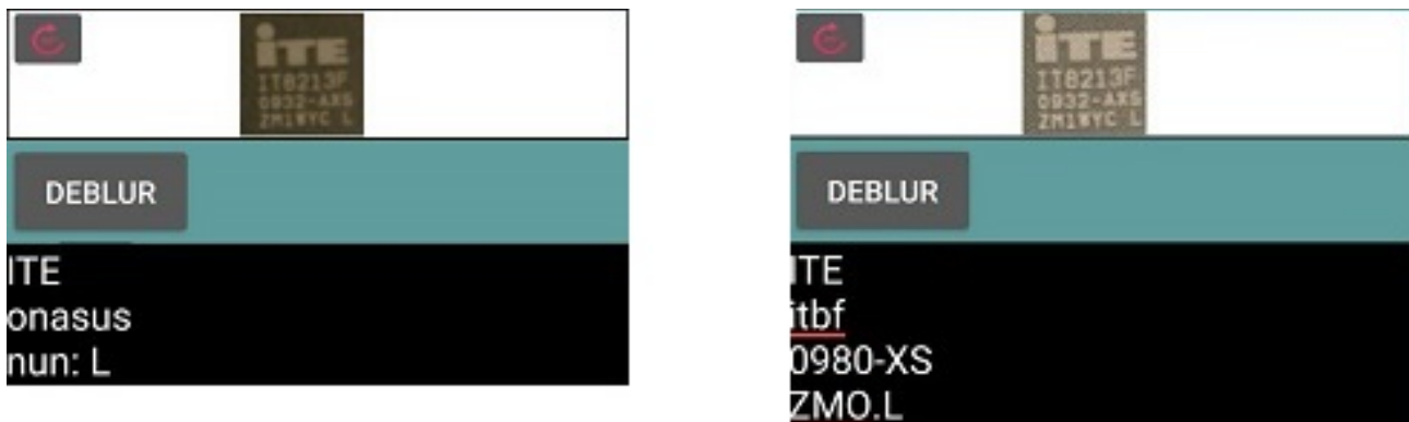
Εικόνα 41: Chip 2x1.5 εκατοστών παράδειγμα δοκιμαστικής εικόνας. Το αποτέλεσμα της αναγνώρισης χωρίς αποκατάσταση της εικόνας εμφανίζεται στο αριστερό μέρος ενώ στο δεξί μέρος παρουσιάζεται το αποτέλεσμα της αναγνώρισης μετά την αποκατάσταση της εικόνας.
