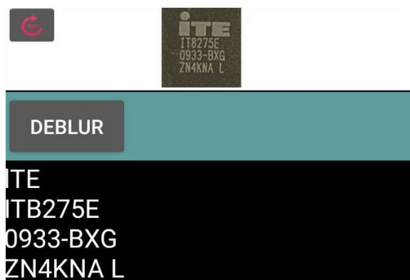
Εικόνα 42: Chip 2x1.5 εκατοστών παράδειγμα δοκιμαστικής εικόνας. Το αποτέλεσμα της αναγνώρισης χωρίς αποκατάσταση της εικόνας εμφανίζεται στο αριστερό μέρος ενώ στο δεξί μέρος παρουσιάζεται το αποτέλεσμα της αναγνώρισης μετά την αποκατάσταση της εικόνας.
