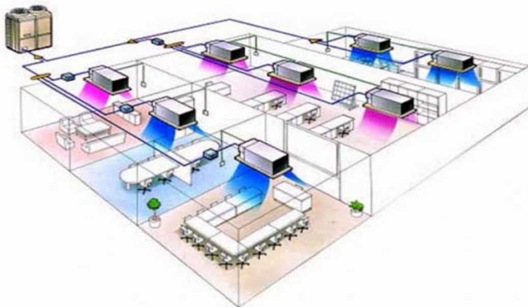
Σχήμα 16. Σχηματική απεικόνιση του συστήματος ψύξης – θέρμανσης (VRF) του εξεταζόμενου κτιρίου.
