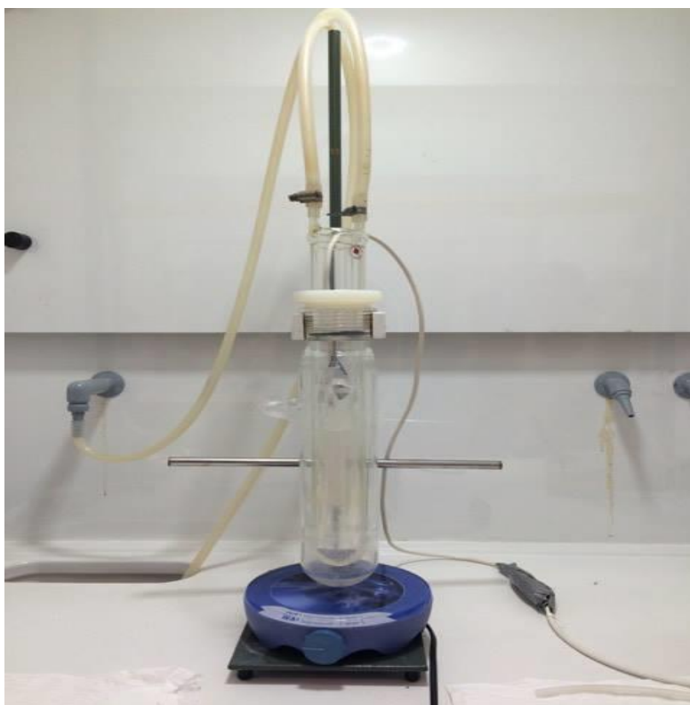
Εικόνα 1 : Φωτοκαταλυτικός αντιδραστήρας με λάμπα UVA
