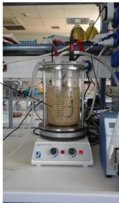
Εικόνα 10: Διάταξη ενεργοποίησης απονιτροποιητικών βακτηρίων
