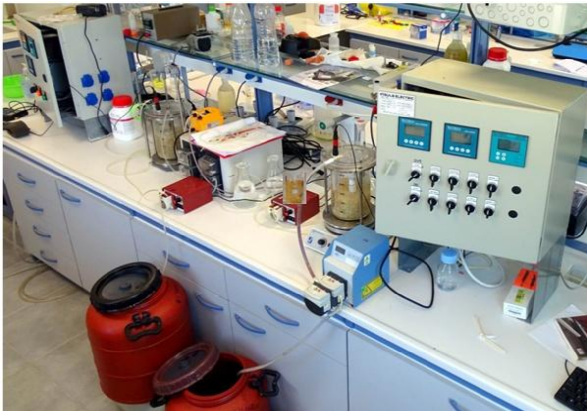
Εικόνα 13 : Συνεχές σύστημα νιτροποίησης – απονιτροποίησης με συνθετικό απόβλητο
