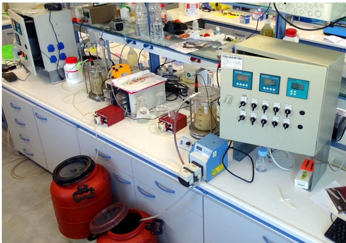
Εικόνα 14 : Συνεχές σύστημα νιτροποίησης – απονιτροποίησης με χρήση αστικού αποβλήτου
