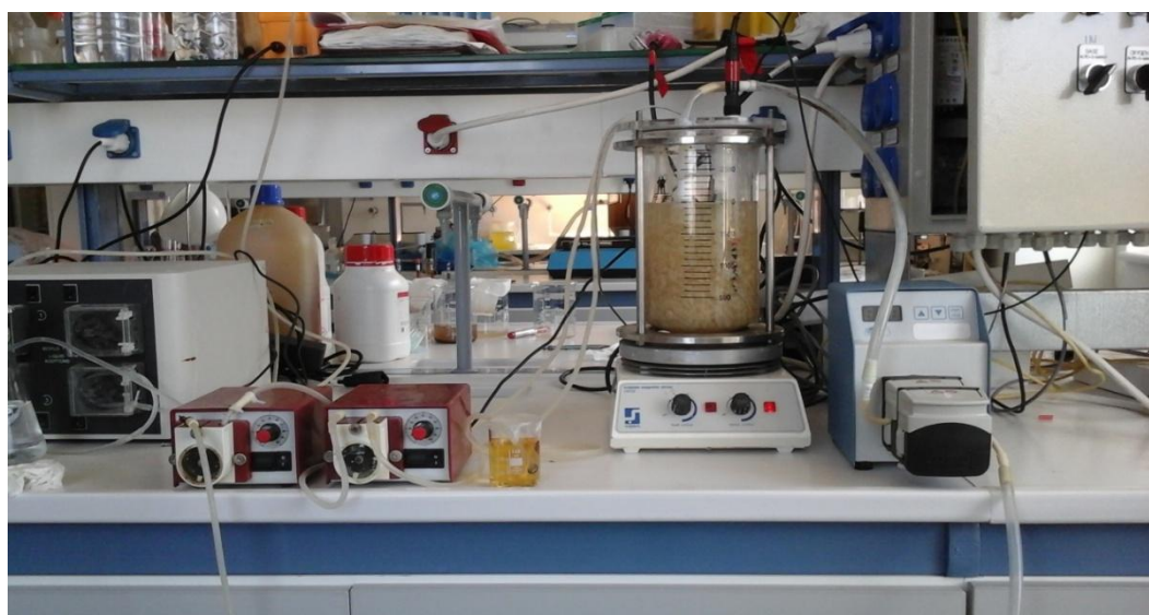
Εικόνα 12: Συνεχές σύστημα απονιτροποιητικών βακτηρίων με τεχνητό απόβλητο
