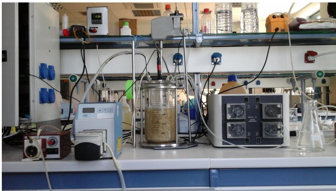
Εικόνα 11: Συνεχές σύστημα νιτροποιητικών βακτηρίων με συνθετικό απόβλητο.
