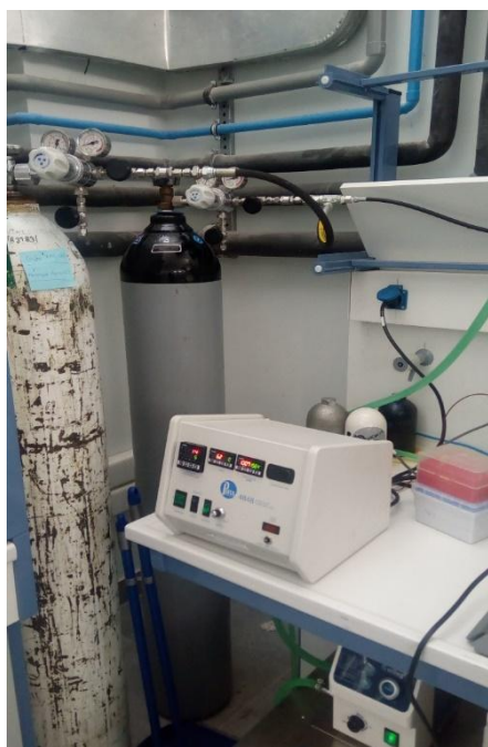
Εικόνα 20: Η συσκευή ελέγχου του αντιδραστήρα και οι φιάλες με την παροχή αέρα και αζώτου
