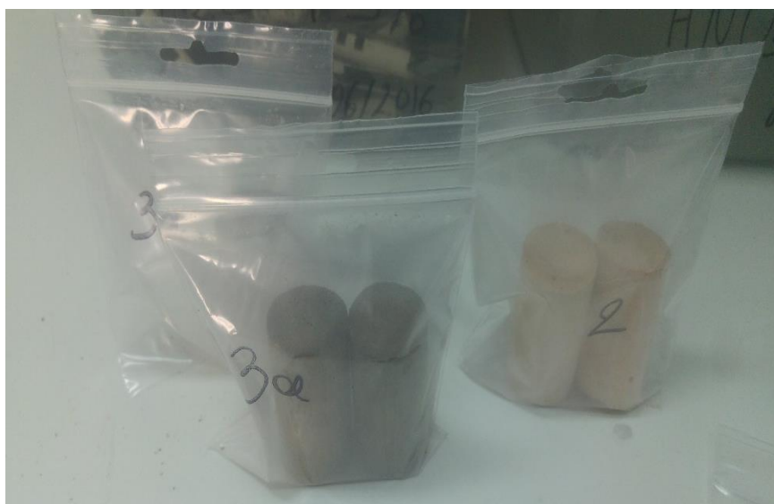
Εικόνα 4.6: Δοκίμια μετά το ξεκαλούπωμα κατά τον χρόνο γήρανσης
