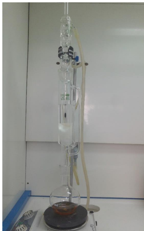
Εικόνα 4.3: Σχεδιαστική απεικόνιση συσκευής Soxhlet (Πηγή: www.researchgate.net ) και πραγματική απεικόνιση κατά τη διάρκεια πειραμάτων στο εργαστήριο
