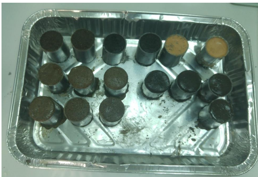
Εικόνα 4.5: Δοκίμια γεωπολυμερών σε κυλινδρικό καλούπι κατά τον χρόνο επώασης
