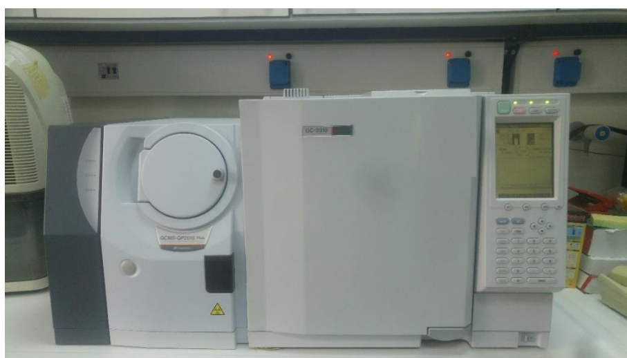
Εικόνα 4.4: Αέριος χρωματογράφος - Φασματόμετρο μάζας υψηλής ανάλυσης εργαστηρίου (Gas Chromatography/Mass Spectrometry-GC/MS)
