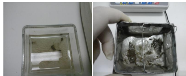
Εικόνα 17: Δείγμα της ανεπεξέργαστης τέφρας μετά το Dynamic test
