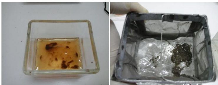
Εικόνα 16: Δείγμα της ανεπεξέργαστης τέφρας μετά το Short test
