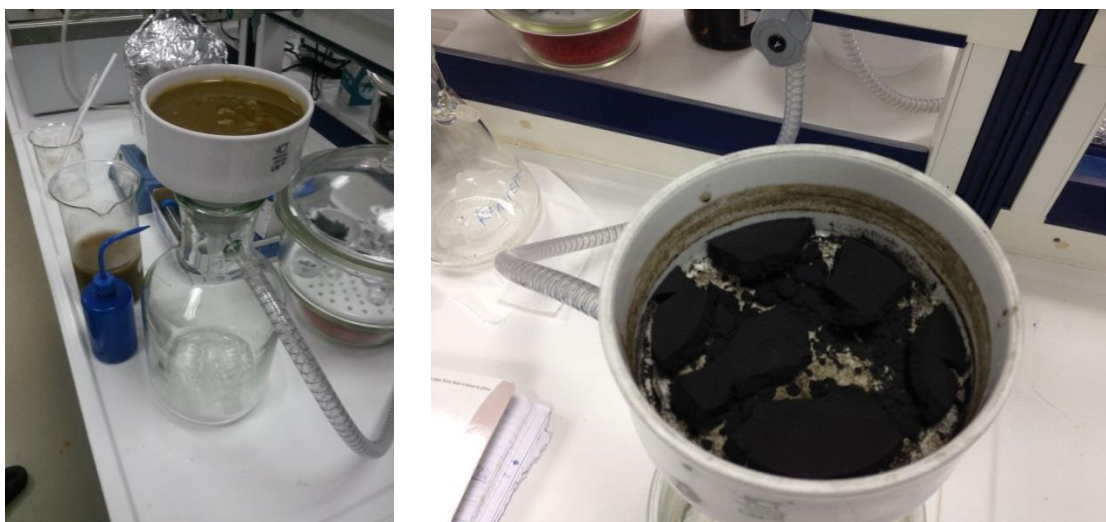
Εικόνα B.5. Διήθηση υπό κενό σε χωνί τύπου Büchner του μίγματος της αντίδρασης με χρήση διηθητικού χαρτιού για την παραλαβή του οξειδίου του γραφίτη.
