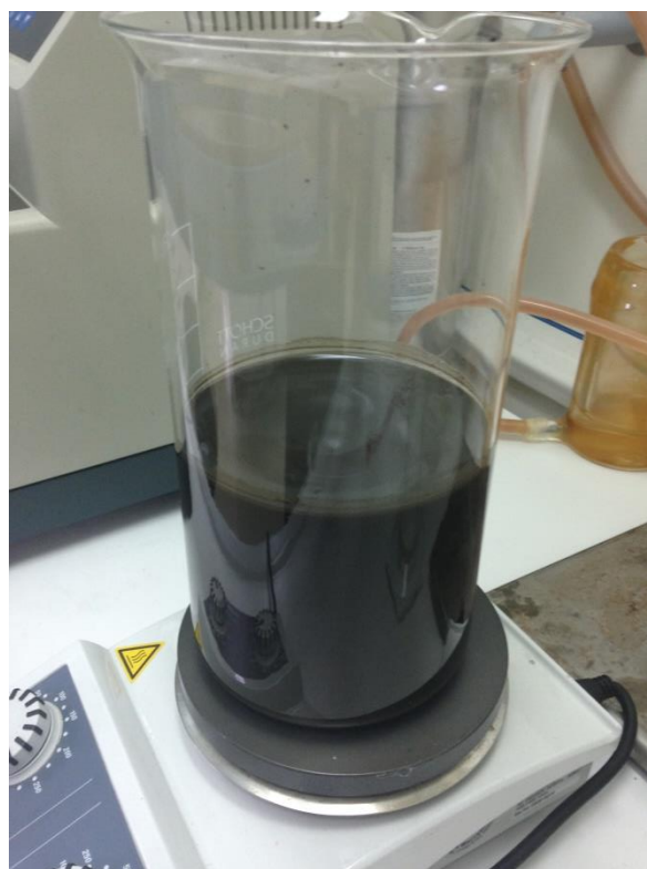
Εικόνα Β.6. Ανάδευση του οξειδίου του γραφίτη με 1 L διαλύματος HCl περιεκτικότητας 3,6% w/w.
