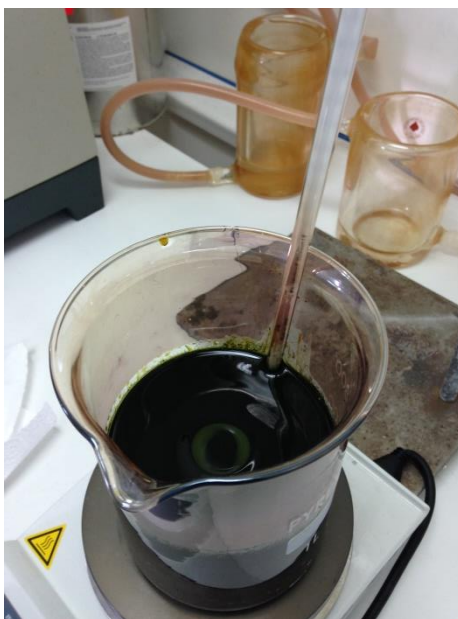
Εικόνα Β.2. Συνεχής ανάδευση του μίγματος της αντίδρασης με συνεχή παρακολούθηση της θερμοκρασίας.
