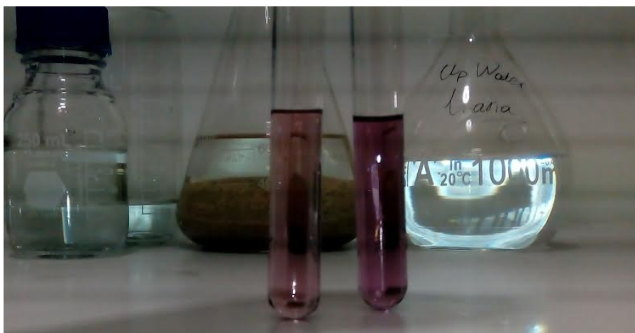
Εικόνα 8.2.2.1: Πλήρης σχηματισμός χρώματος στο προϊόν της αντίδρασης τελομερισμού τρυπαμίνης-FA, για αρχική συγκέντρωση φορμαλδεΰδης 5mg/L.
