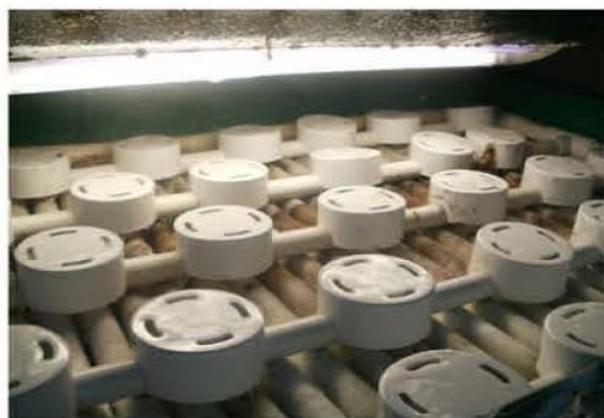
Εικόνα 14: Ανάπτυξη βιοφίλμ μετά από 2 μήνες λειτουργίας του συστήματος
