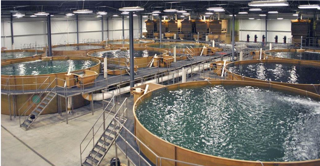
Εικόνα 4: Τυπικό δείγμα εγκατάστασης συστήματος υδατοκαλλιέργειας με επανακυκλοφορία
