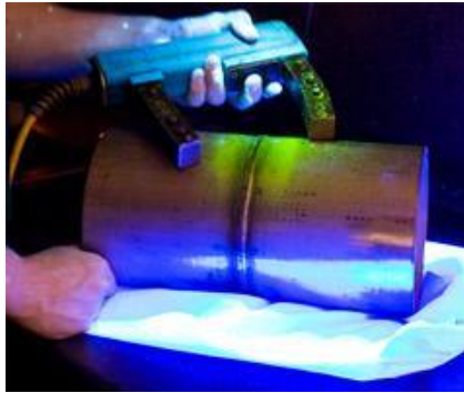
Εικόνα 40: Εντοπισμός Αστοχίας με τη Μέθοδο των Μαγνητικών Σωματιδίων
