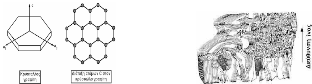
Εικόνα 11: Δομή Ίνας Άνθρακα
