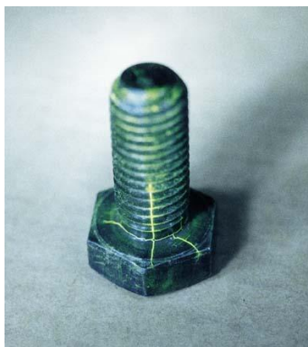
Εικόνα 38: Εντοπισμός Αστοχίας με τη Χρήση Διεσδυτικού Υγρού
