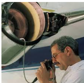
Εικόνα 37: Εξέταση Τεμαχίου με την Οπτική Μέθοδο
