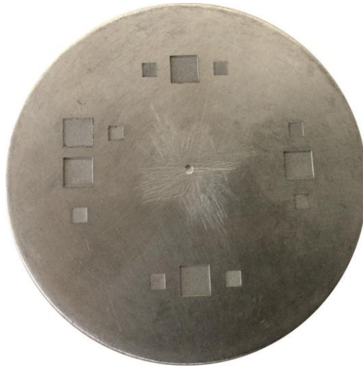
Σχήμα 4.39: Technologies και δοκιμαστικές κοπές στην πίσω πλευρά του δίσκου στον οποίο χαράχθηκε ο Δαίδαλος
