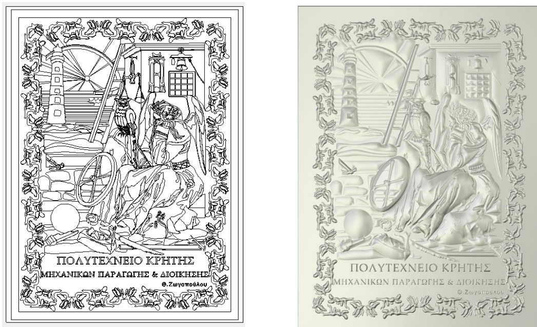
Σχήμα 4.59: Αριστερά: Δυσδιάστατη απεικόνιση του σχεδίου της Σύνθεσης στο πρόγραμμα ArtCAM, Δεξιά: Τρισδιάστατη κατακόρυφη απεικόνιση της πλακέτας της Σύνθεσης
