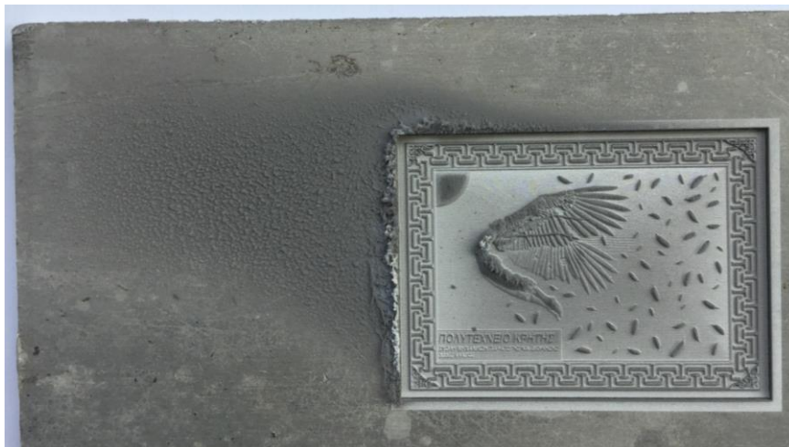
Σχήμα 4.53: Το κατεργασμένο τεμάχιο της πλακέτας του Ικάρου, με την σκόνη στην αριστερή πλευρά
