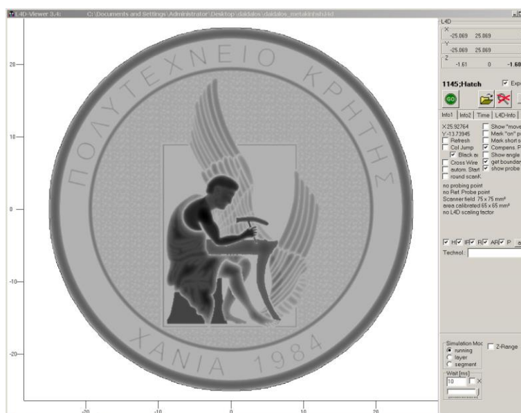
Σχήμα 4.34: Παράθυρο από το πρόγραμμα L4DViewer, αφού έχει τελειώσει η προσομοίωση της κατεργασίας του Δαίδαλου
