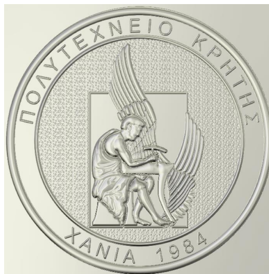
Σχήμα 4.4: Αριστερά: Δυσδιάστατη απεικόνιση του σχεδίου του Δαίδαλου στο πρόγραμμα ArtCAM, Δεξιά: Τρισδιάστατη κατακόρυφη απεικόνιση του μεταλλίου με το Δαίδαλο
