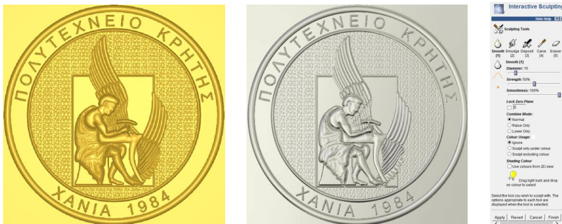
Σχήμα 4.28: Αριστερά: Παράθυρο εφαρμογής των εντολών στο μοντέλο του μετάλλου, Κέντρο: Ολοκληρωμένο μετάλλιο μετά την επεξεργασία με τις εντολές “Deposit” και “Smooth”, Δεξιά: Παράθυρο επιλογής εντολών από την ομάδα “Sculpting tools” και παραμέτρων τους
