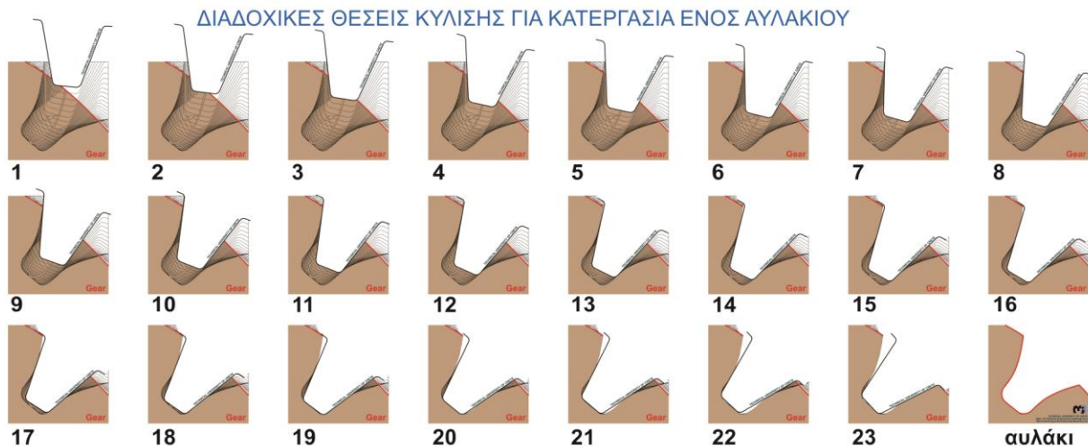
Σχήμα 2.33: Θέσεις κύλισης στο φραιζάρισμα με κύλιση οδοντώσεων
