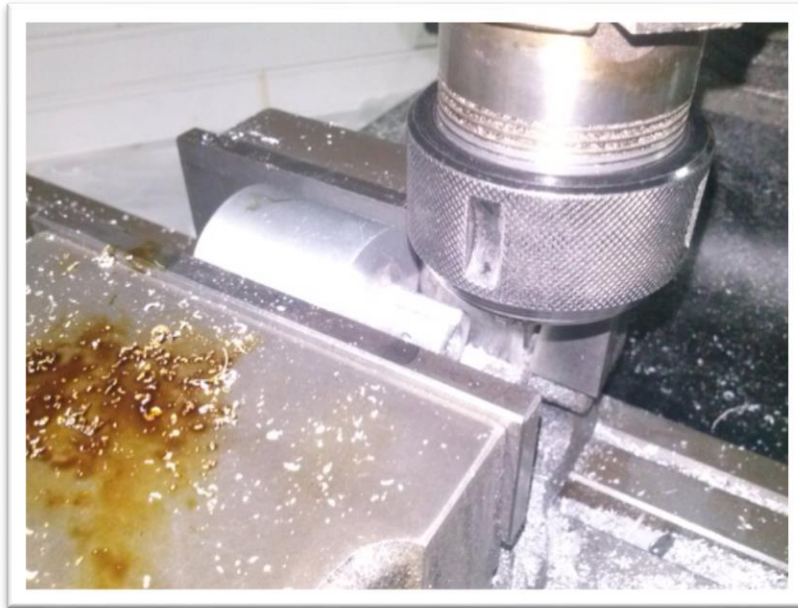
Εικόνα 5.12: Κατασκευή σφηναύλακας στην φρέζα
