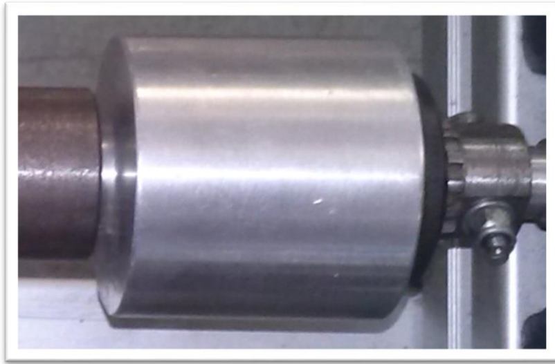
Εικόνα 4.13: Η «φωλιά» κατασκευασμένη από αλουμίνιο
