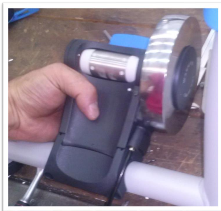
Εικόνα 5.15: Σημείο έδρασης εργόμετρου στην εργοστασιακή βάση
