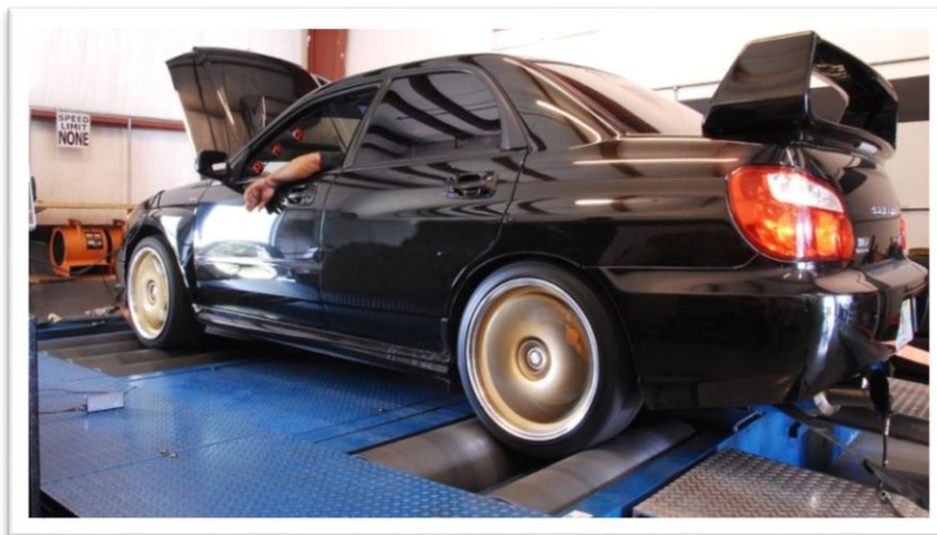
Εικόνα 2.2: Δυναμόμετρο Σασί (Chassis Dynamometer)
