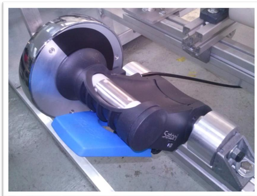
Εικόνα 5.20: Εργόμετρο τοποθετημένο στην αυτοσχέδια βάση του. Διακρίνονται οι σύνδεσμοι-γωνίες
