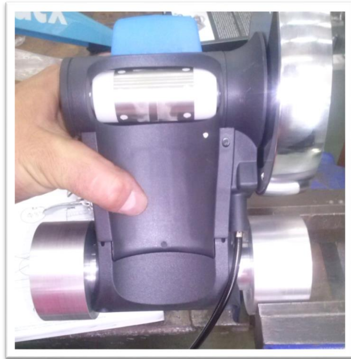
Εικόνα 5.19: Έλεγχος εφαρμογής του εργομέτρου στην αυτοσχέδια βάση
