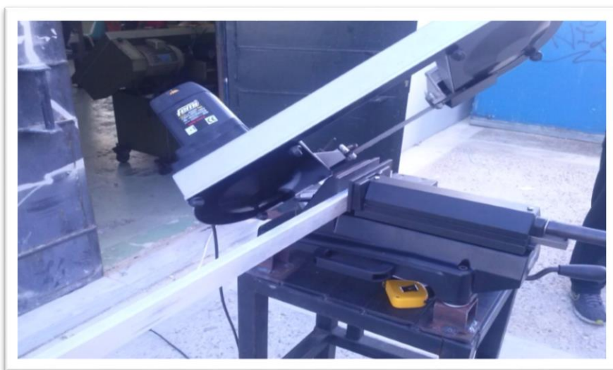
Εικόνα 5.1: Κοπή δοκών αλουμινίου έξω από το εργαστήριο εργαλειομηχανών
