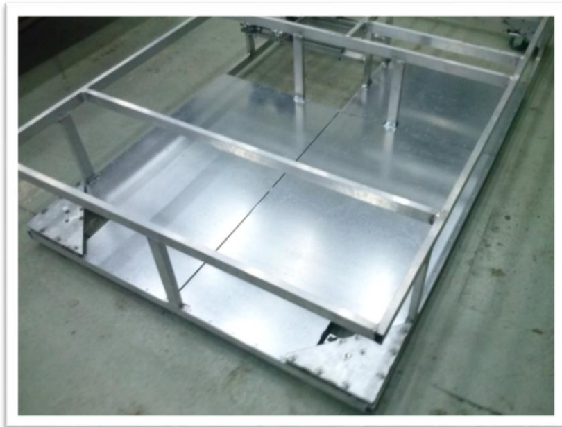
Εικόνα 3.11: Τοποθετημένες λαμαρίνες αποθηκευτικού χώρου
