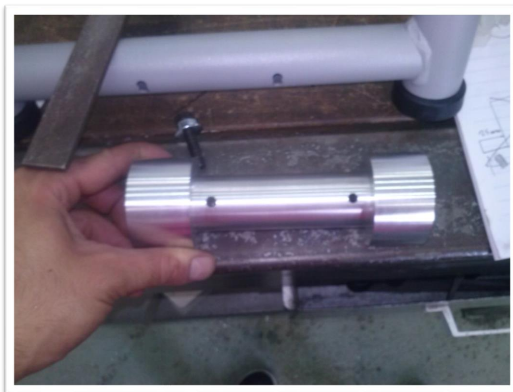
Εικόνα 5.18: Ολοκληρωμένη βάση εργόμετρου για τοποθέτηση στην βάση δοκιμών
