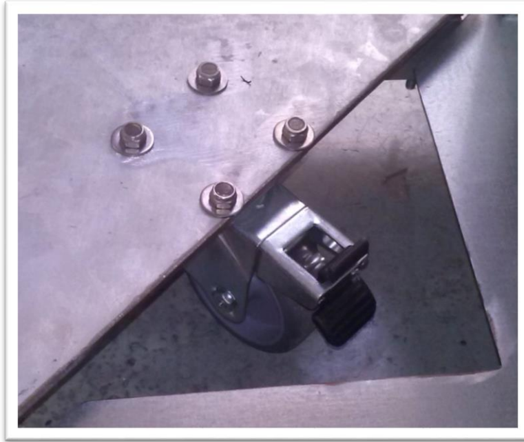
Εικόνα 3.9: Ρόδες με δυνατότητα κίνησης προς κάθε κατεύθυνση και μηχανικό φρένο
