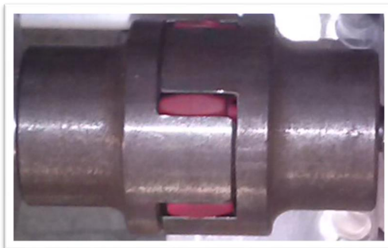
Εικόνα 4.14: Σύνδεσμος Άξονα (Silent Block)
