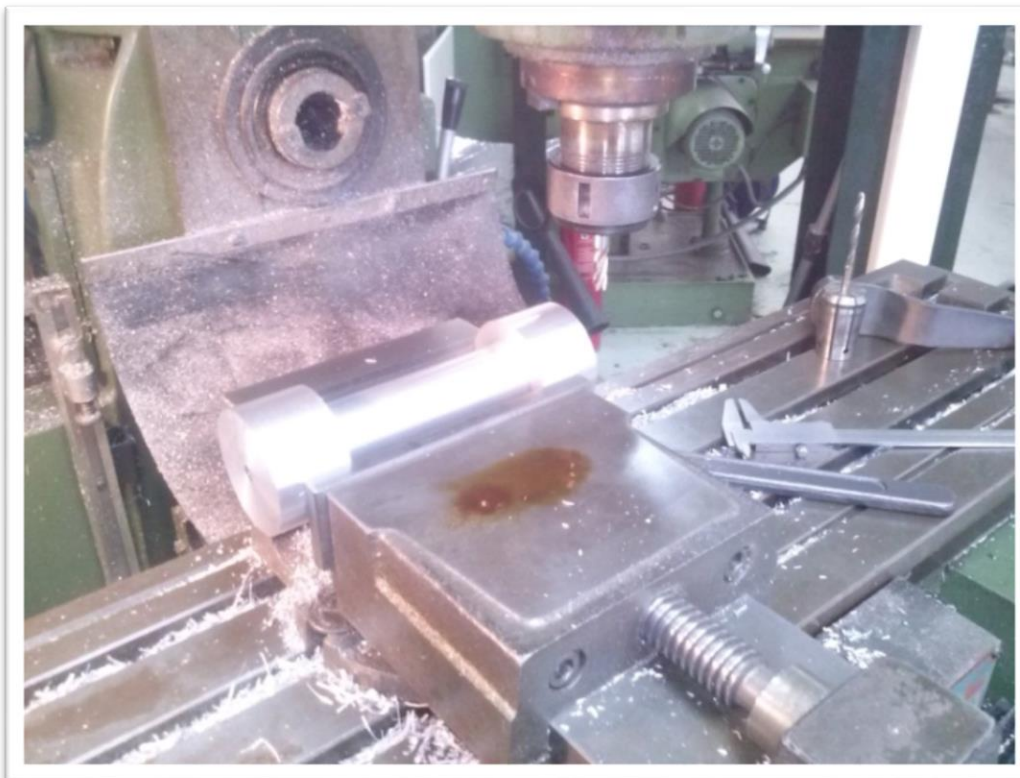
Εικόνα 5.17: Κατεργασία διάτρησης στην φρέζα
