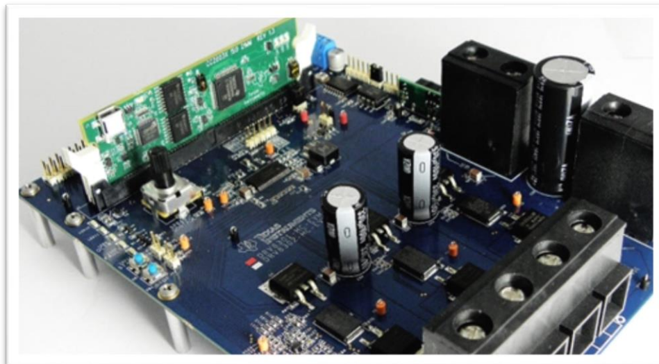
Εικόνα 7.2: Ηλεκτρονικός Ελεγκτής Texas Instruments DRV8301
