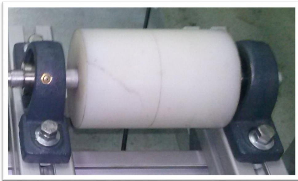
Εικόνα 5.11: Ράουλο ολίσθησης και έδραση του
