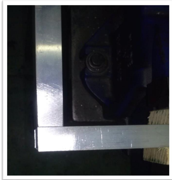
Εικόνα 5.3: Βούρτσισμα και ευθυγράμμιση σημείου συγκόλλησης
