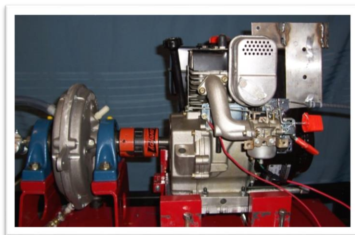
Εικόνα 2.1: Δυναμόμετρο Κινητήρα (Engine Dynamometer)
