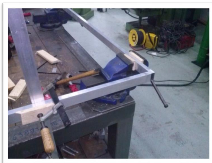
Εικόνα 5.4: Κάθετη συγκράτηση πλαισίου βάσης προς συγκόλληση
