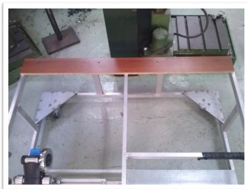
Εικόνα 3.10: Ξύλινη επιφάνεια για εργασία στο όχημα σε καθιστή θέση
