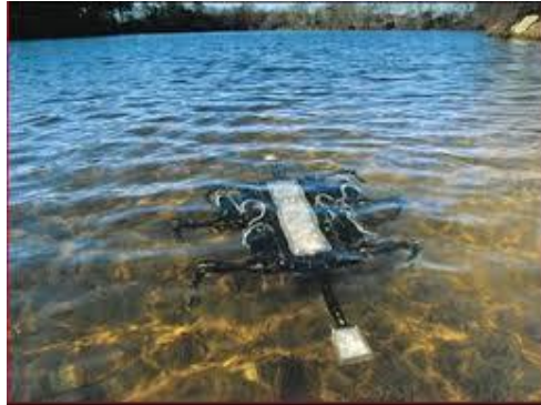
Εικόνα 2.1: Το ρομπότ Ariel κάτω από το βυθό σε μία λίμνη στη Βοστώνη. Κινείται πλάγια ακριβώς όπως ένα καβούρι
