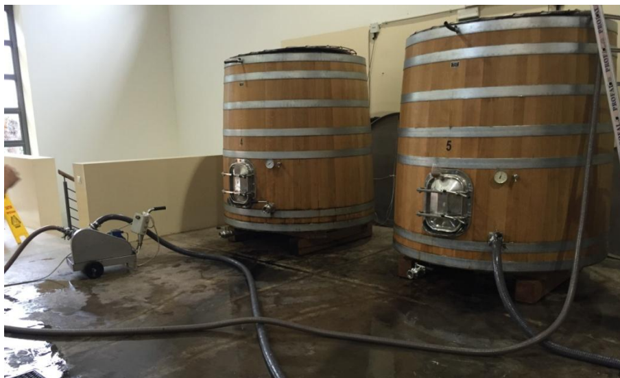
Εικόνα 4.10. Ανακύκλωση ερυθρού οίνου σε δρύινη δεξαμενή
