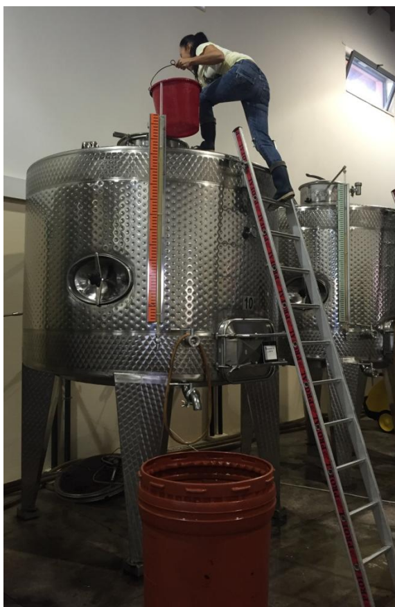
Εικόνα 4.11. Ανακύκλωση-Αερισμός λευκού οίνου / Ενισχυτικό θρεπτικό
