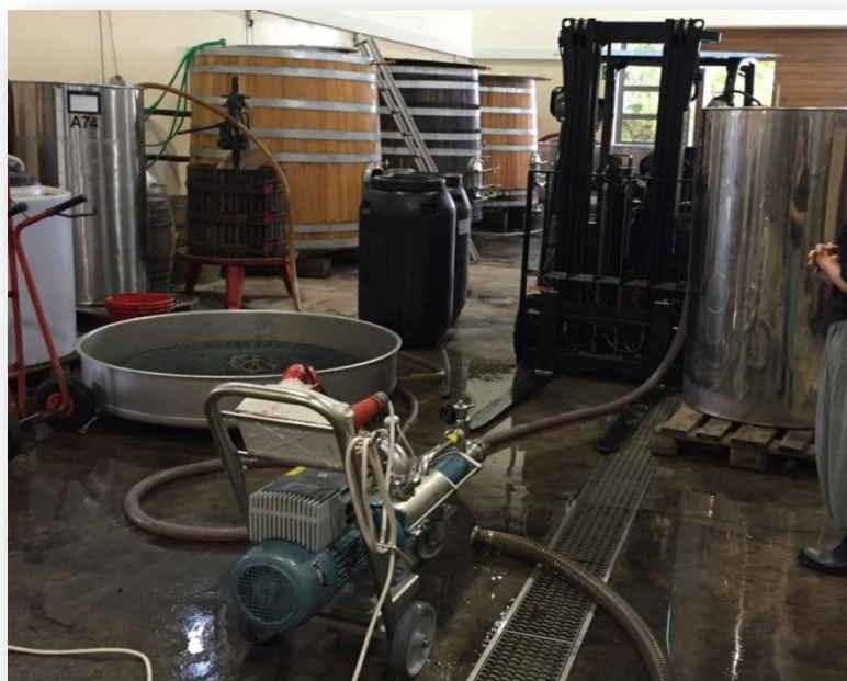
Εικόνα 4.12. Διαδικασία απολάσπωσης ροζέ οίνου με τη χρήση αντλιών
