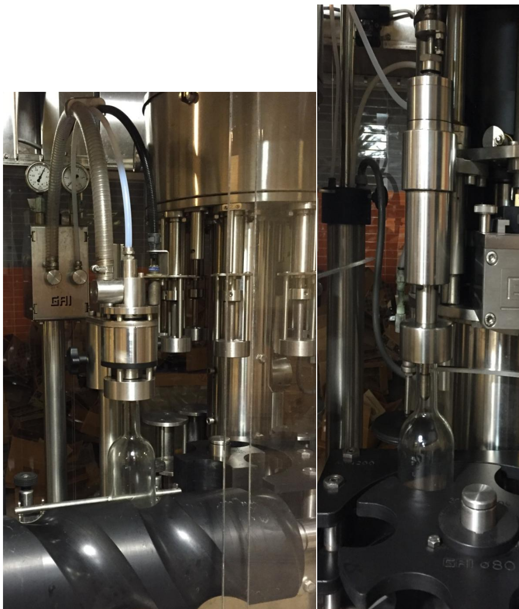
Εικόνα 4.16. Γέμισμα φιάλης - Ρύθμιση Στάθμης του κρασιού
