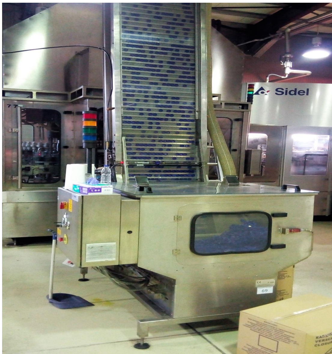
Εικόνα 24: Δεξαμενή πωμάτων
