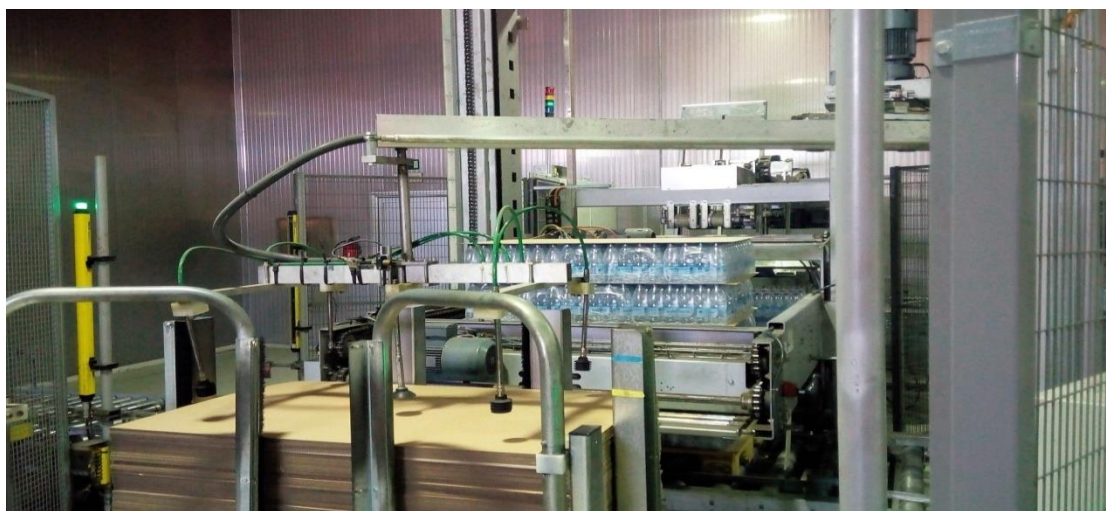
Εικόνα 35: Τοποθέτηση χαρτόδισκων στη παλέτα
