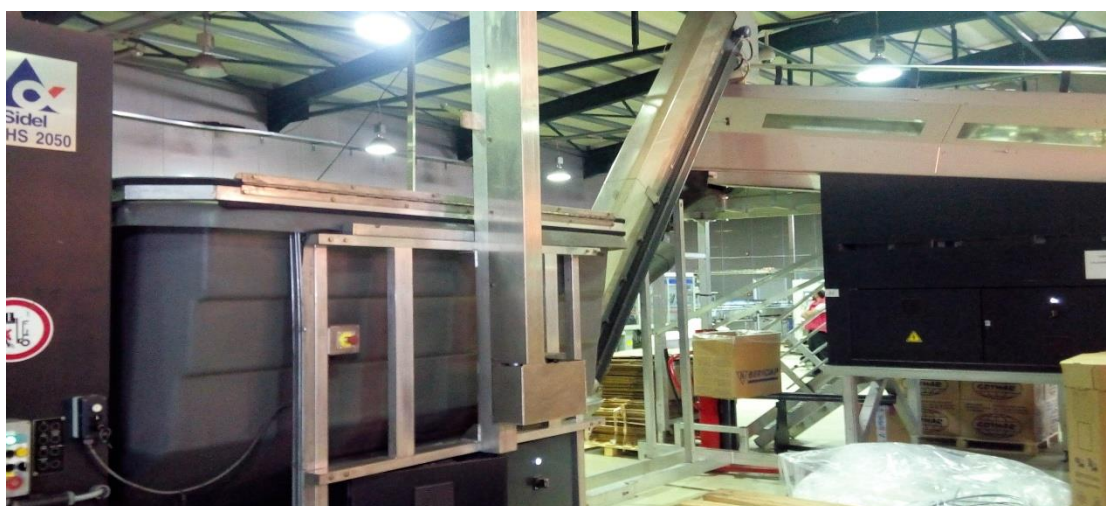
Εικόνα 20: Μεταφορά preforms στο αναβατήριο
