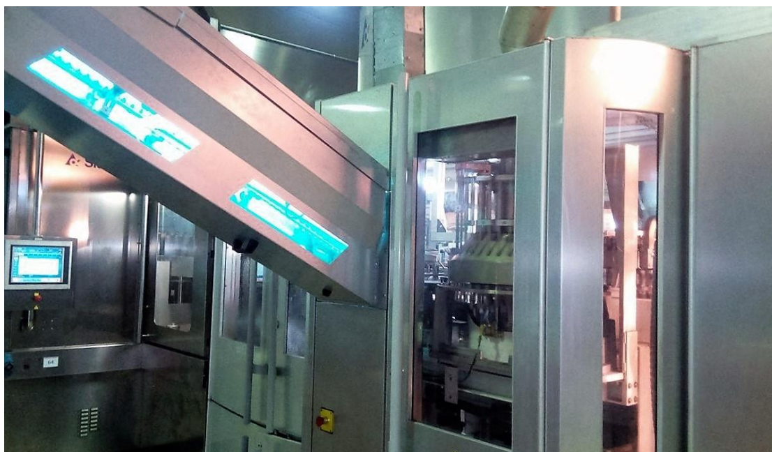
Εικόνα 22: Αερομεταφορά preforms (είσοδος στο μονoblock)
