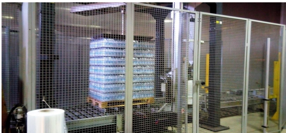
Εικόνα 37: Τοποθέτηση stretch film από την τυλιχτική μηχανή
