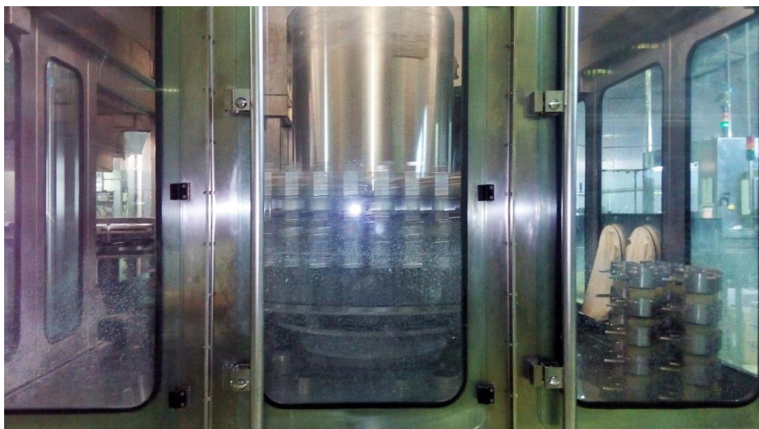
Εικόνα 25: Γεμιστική μηχανή και πωματέζα
