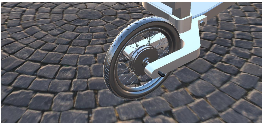
Εικόνα 12.8: Κινητήρες τύπου HUB
