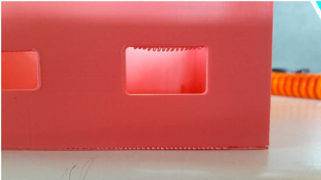
Εικόνα 11.13: Απροσδιόριστη στερεοποίηση υλικού
