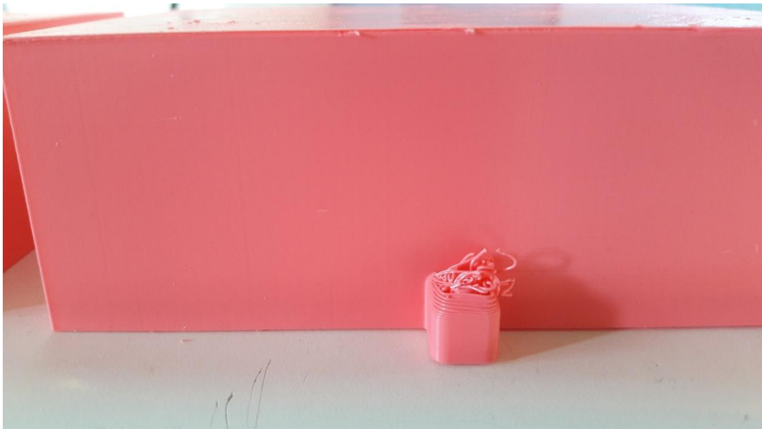
Εικόνα 11.9: Εκτύπωση χωρίς τη χρήση στηριγμάτων
