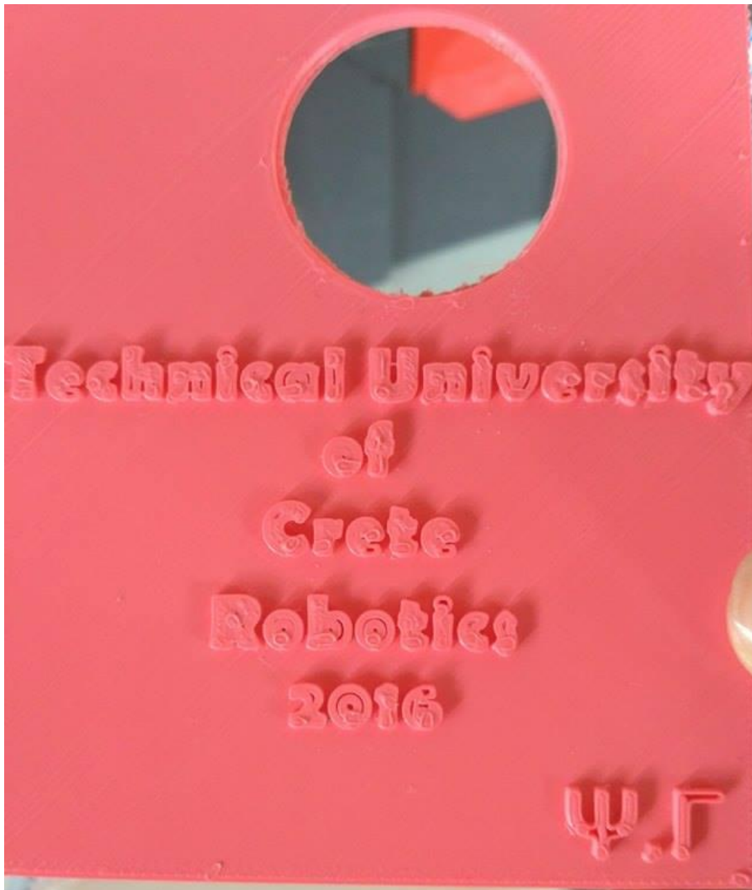
Εικόνα 11.14: Απόδοση γραμμάτων από το 3D printer
