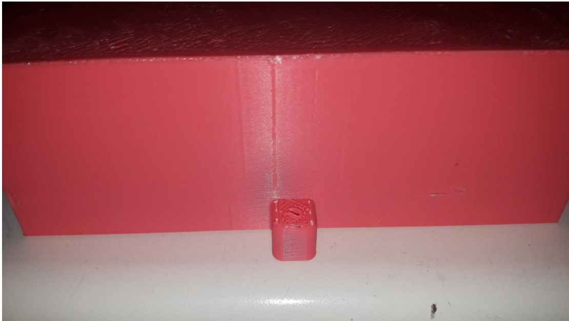
Εικόνα 11.8: Εκτύπωση με χρήση στηριγμάτων
