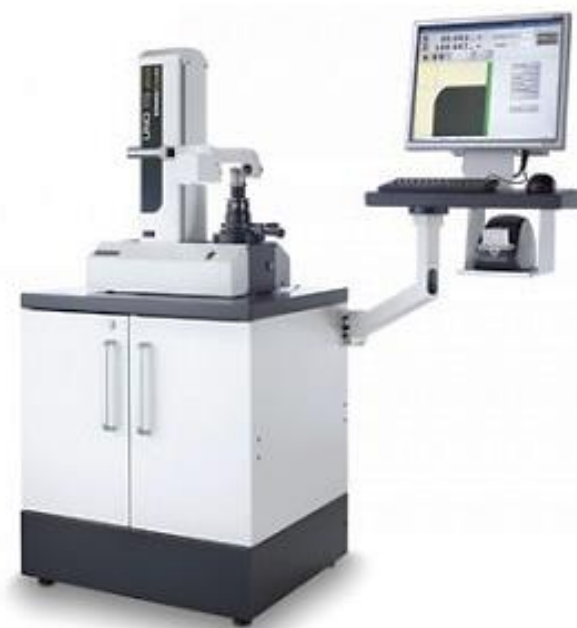
Σχήμα 4.2 : Η εξωτερική συσκευή προорύθμισης των κοπτικών και μετρητικών εργαλείων DMG Microset Uno 115 eco.
