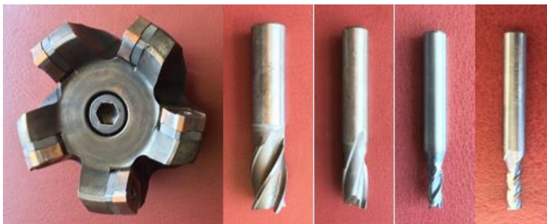
Σχήμα 4.4 : Κονδύλια διαφόρων διαμέτρων (από αριστερά προς τα δεξιά) : 1) κονδύλι διαμέτρου d = 63 mm και 5 δοντιών (αυλακώσεων) που χρησιμοποιείται για επίπεδο φραιζάρισμα μεγάλων επιφανειών, 2) κονδύλι διαμέτρου d = 17 mm και 4 δοντιών (αυλακώσεων), 3) κονδύλι διαμέτρου d = 10 mm και 4 δοντιών (αυλακώσεων), 4) κονδύλι διαμέτρου d = 6 mm και 3 δοντιών (αυλακώσεων) και 5) κονδύλι διαμέτρου d = 2 mm και 3 δοντιών (αυλακώσεων).
