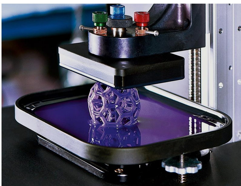
Σχήμα 2.24 : Προσθετική κατασκευή αντικειμένου σε πραγματικό χρόνο μέσω της τεχνολογίας CLIP με χρήση του σχετικού υλικοτεχνικού εξοπλισμού.
