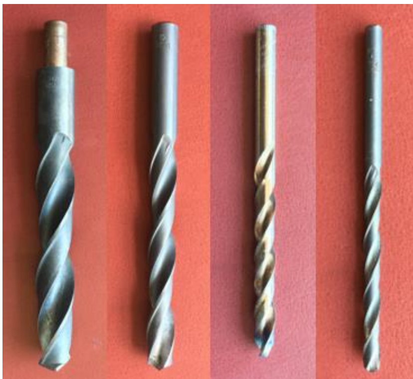
Σχήμα 4.6 : Στάνταρ τρυπάνια διαφόρων διαμέτρων (από αριστερά προς τα δεξιά) : 1) τρυπάνι διαμέτρου d = 20 \text{ mm} και 2 αυλακώσεων, 2) τρυπάνι διαμέτρου d = 12 \text{ mm} και 2 αυλακώσεων, 3) τρυπάνι διαμέτρου d = 8 \text{ mm} και 2 αυλακώσεων και 4) τρυπάνι διαμέτρου d = 5 \text{ mm} και 2 αυλακώσεων.
