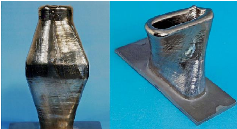
Σχήμα 2.16 : Αντικείμενα προσθετικά κατασκευασμένα μέσω της τεχνολογίας EBF 3 .
