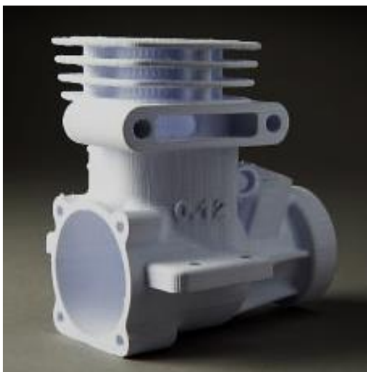
Σχήμα 2.14 : Προσθετικά κατασκευασμένο εξάρτημα μέσω της τεχνολογίας LOM.
