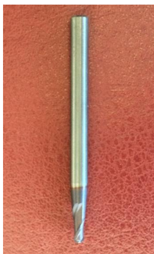
Σχήμα 4.5 : Κονδύλι σφαιρικής απόληξης διαμέτρου d = 2 mm και 2 αυλακώσεων.
