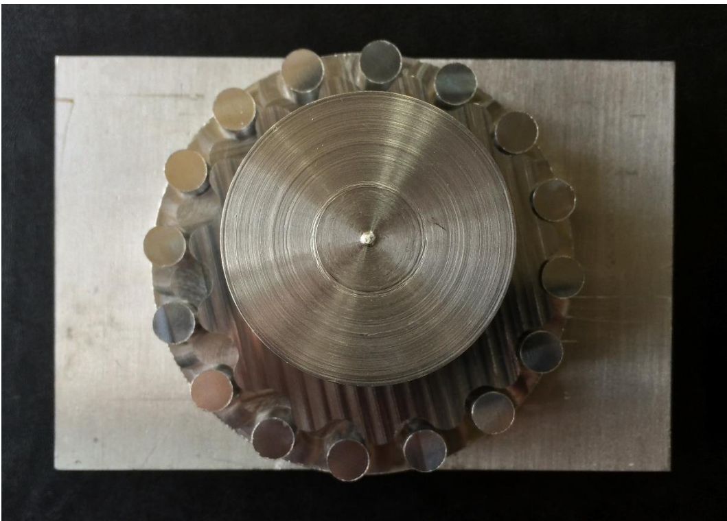
Σχήμα 6.23γ' : Πλήρης συναρμολόγηση της διάταξης του κυκλοειδούς μειωτήρα ταχύτητας.
