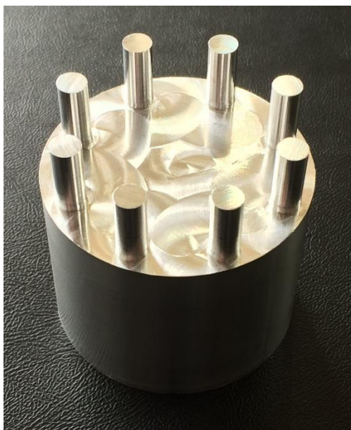
Σχήμα 6.22 : Ο τελικός παραχθέντας άξονας εξόδου.
