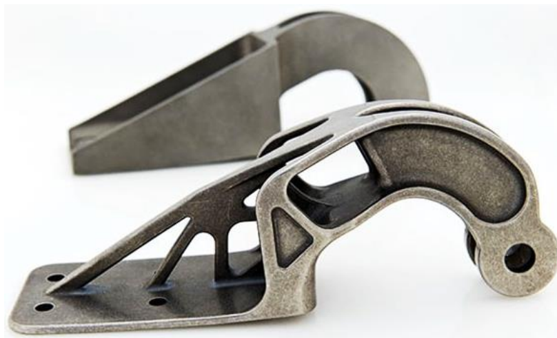
Σχήμα 2.18 : Προσθετικά κατασκευασμένες αρθρώσεις (μεντεσέδες) μέσω της τεχνολογίας EBM οι οποίες προορίζονται για τη μηχανή του αεροσκάφους A380 της Airbus.
