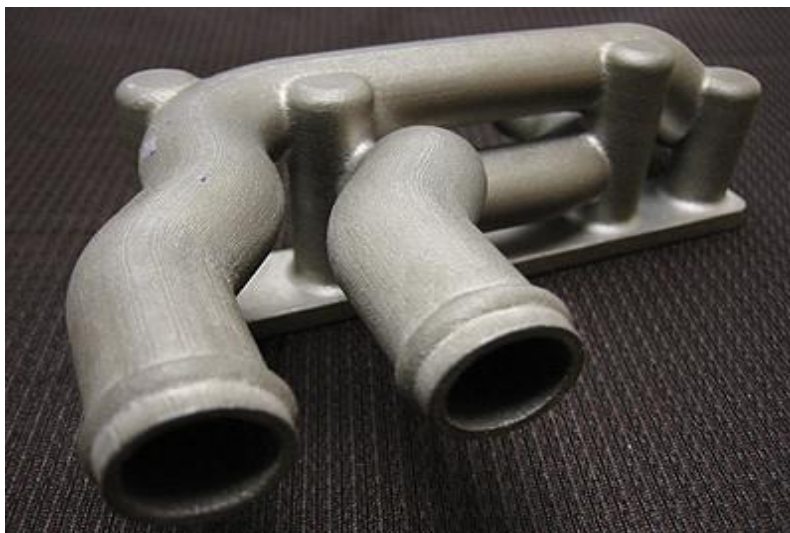
Σχήμα 2.20 : Διάταξη εξάτμισης αυτοκινήτου προσθετικά κατασκευασμένη μέσω της τεχνολογίας DMLS.
