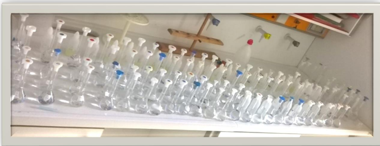
(Εικόνες 30) Δείγματα (18 σε αριθμό) μεικτών θειούχων μετα τη διαλυτοποίηση ( απο Γ και Δ φάση ), αραιώσεις (54) που χρειάστηκαν να γίνουν, και τα πρότυπα (17) που χρησιμοποιήθηκαν για τις μέτρησεις με το φασματοφωτόμετρο, για τη Γ και Δ φάση.
