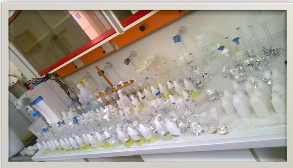
(Εικόνες 29) Δείγματα (36 σε αριθμό) μεικτών θειούχων μετα τη διαλυτοποίηση (απο A+Bφάση ), αραιώσεις (108) που χρειάστηκαν να γίνουν, και τα πρότυπα (14) που χρησιμοποιήθηκαν για τις μέτρησεις με το φασματοφωτόμετρο, για τις δυο πρώτες φάσεις .
