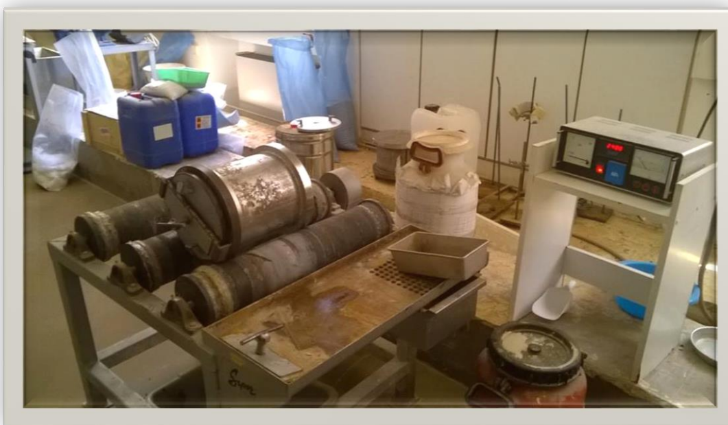
(εικόνες 9) Εργαστηριακός μύλος (ραβδόμυλος)
