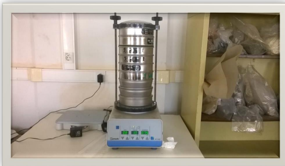
(Εικόνα 11) Εργαστηριακός δονητής κοσκίνων
