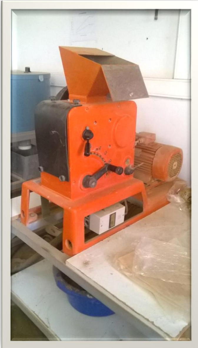
( εικόνα 4 ) Εργαστηριακός σιαγονωτός σπαστήρας
