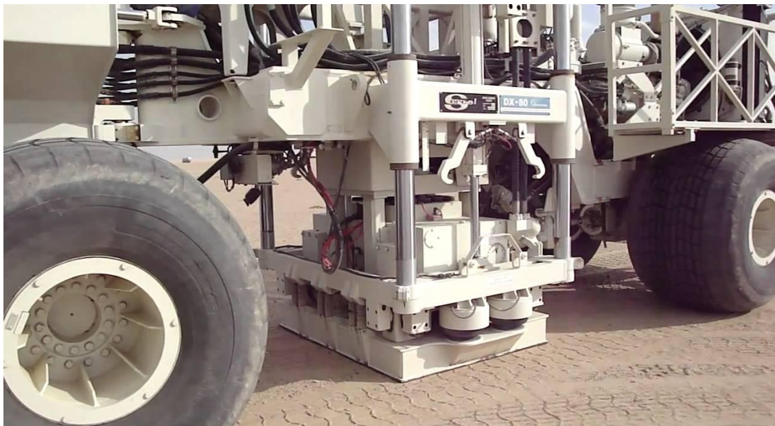
Σχήμα 1.7: Μηχάνημα Vibroseis, η πιο διαδεδομένη σεισμική πηγή. (εικόνα από: https://www.youtube.com/watch?v=4EI6U0XTNS0 )
