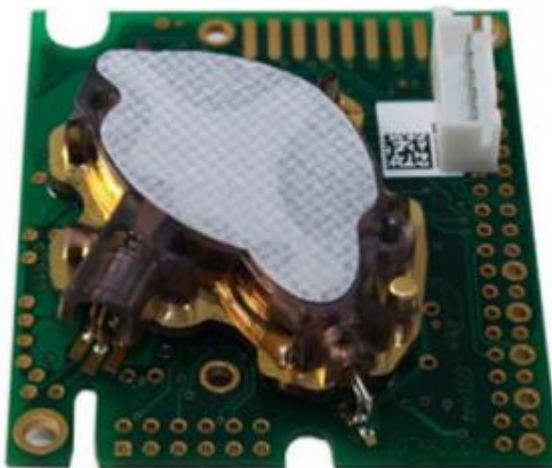
Σχήμα 2-23. Ο αισθητήρας διοξειδίου του άνθρακα K-30
