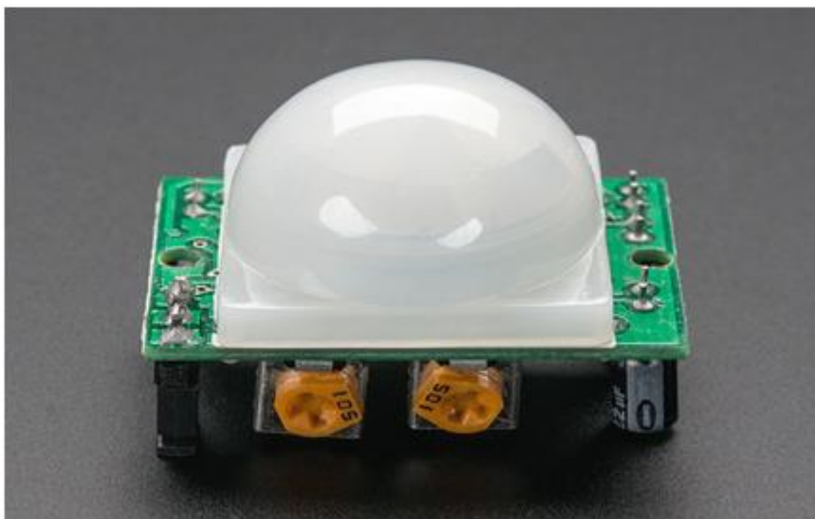
Σχήμα 2-26. Ο αισθητήρας ανίχνευσης κίνησης PIR
