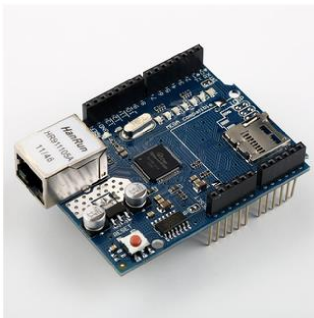
Σχήμα 2-3. Η συμβατή με το Arduino Mega 2560, Ethernet Shield
