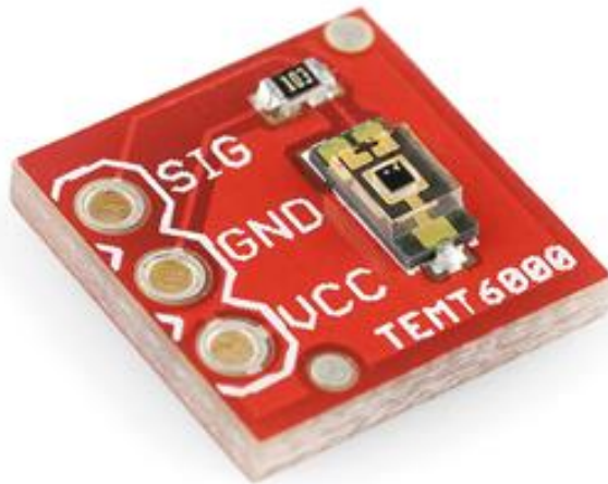
Σχήμα 2-15. Ο αισθητήρας φωτός TEMT6000
