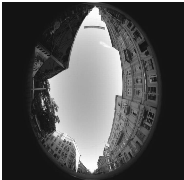
Εικόνα 1.3 : Fish-eye φωτογραφία από αστική οδική χαράδρα που απεικονίζει τη τιμή του δείκτη SVF
