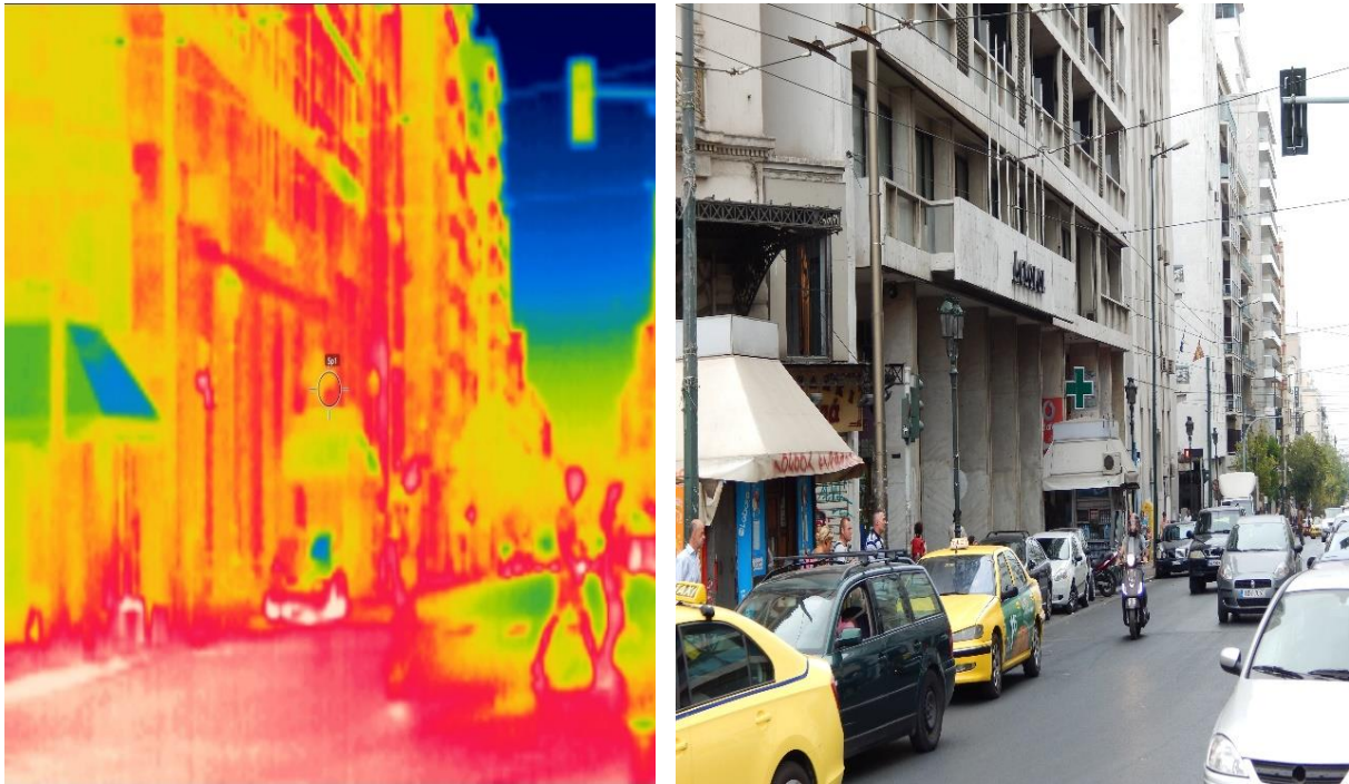
Εικόνα 4.6 : Αποψη της οδού Πειραιώς στο (αριστερά) υπέρυθρο φάσμα και (δεξιά) στο ορατό
